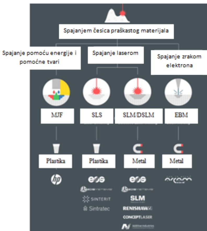
Slika 8. Sistematizacija PBF postupka [7]
