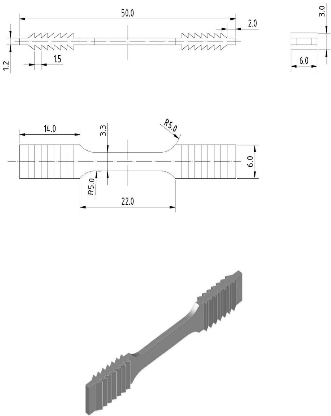
Slika 24. Crtež i 3D prikaz epruvete
