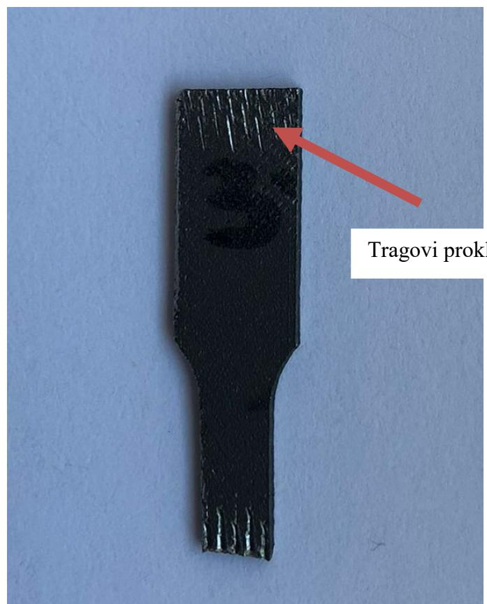
Slika 1. Tragovi proklizavanja na epruveti
