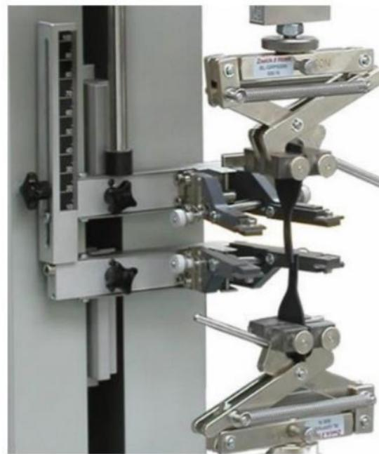
Slika 21. Automatski ekstenzimetr [20]
