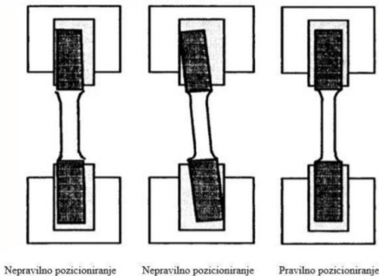
Slika 19. Nepravilno i pravilno pozicioniranje epruvete [21]
