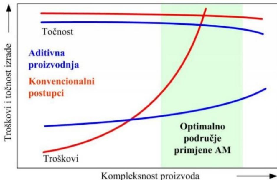
Slika 6. Opravdanost primjene postupaka aditivne proizvodnje [3]
