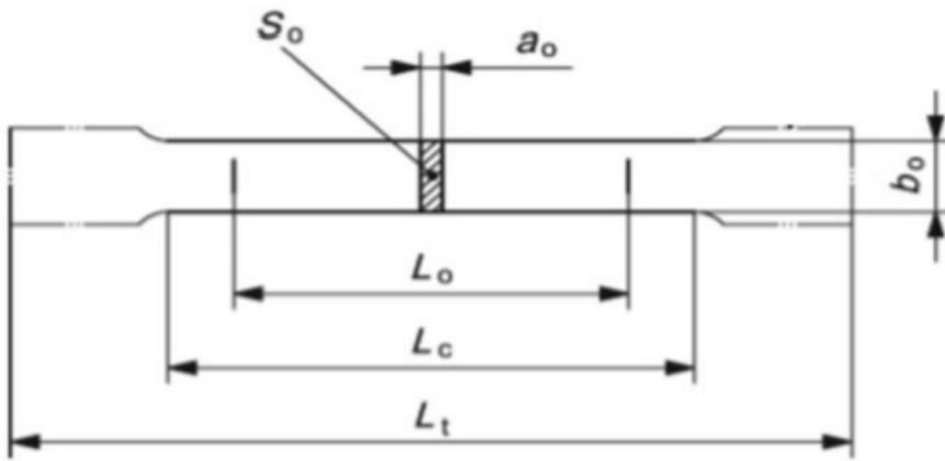
Slika 18. Epruveta s četvrtastim poprečnim presjekom [18]
