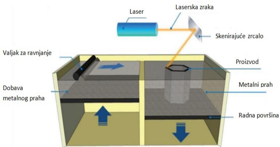
Slika 10. Shematski prikaz SLM postupka proizvodnje [11]
