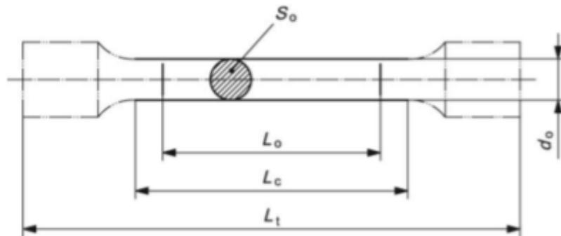
Slika 17. Epruveta s okruglim poprečnim presjekom [18]
