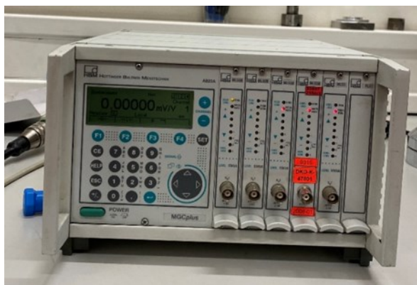
Slika 11. Mjerno pojačalo Hottinger Baldwin Messtechnik
