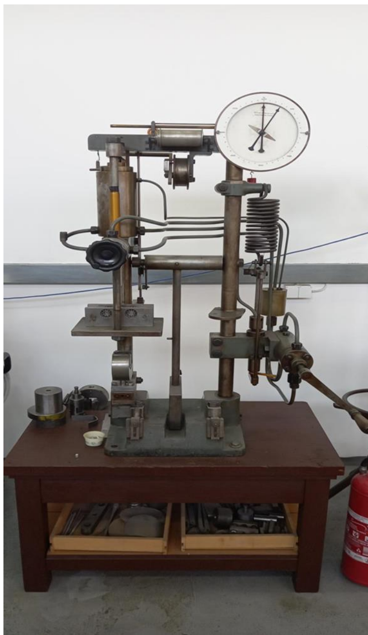
Slika 11. Uređaj za savijanje u Laboratoriju za oblikovanje deformiranjem
