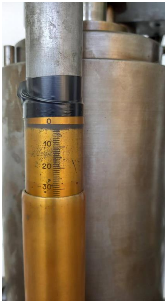
Slika 14. Uredaj za očitavanje elastičnog povrata
