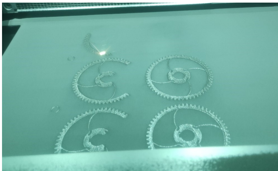
Slika 21. Srašćivanje sloja tijekom DMLS postupka
