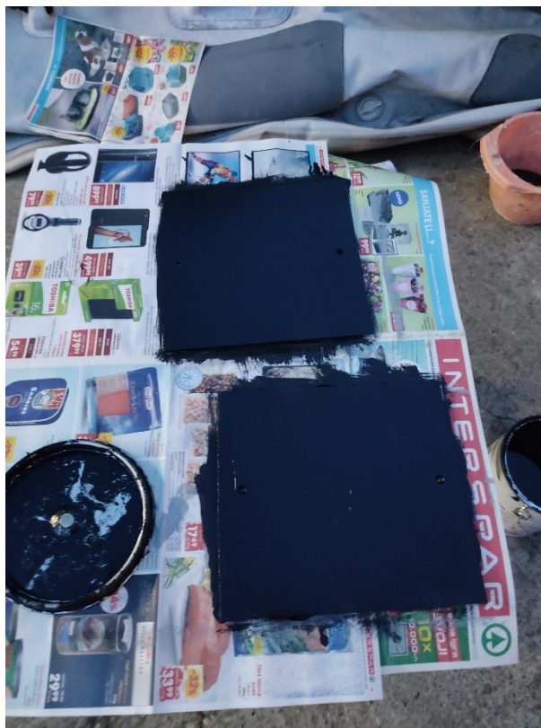
Slika 5.23 Test ploče nakon nanošenja premaza protiv obraštaja
