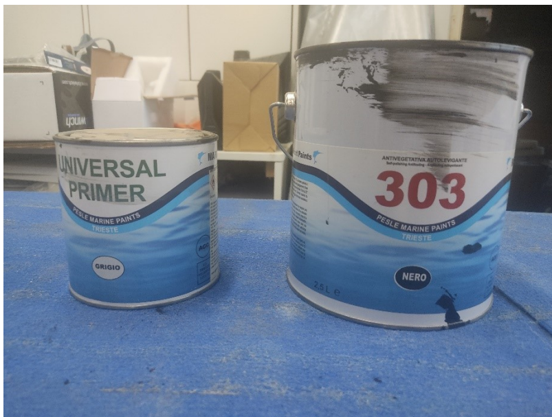
Slika 5.21 Temeljni premaz i premaz protiv obraštaja
