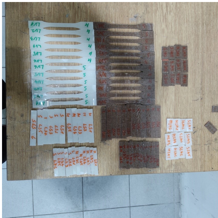
Slika 4.17 Epruvete za ispitivanje mehaničkih svojstva
