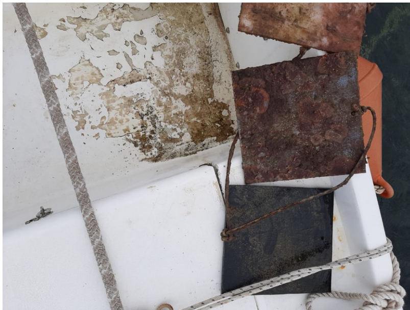
Slika 5.24 Test ploče nakon 120 dana
