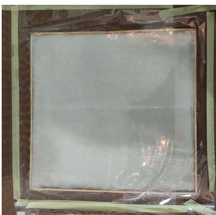
**Slika 4.11 Završetak laminiranja i priprema sušenja**
