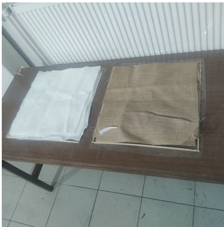
Slika 4.10 Priprema vlakana za laminiranje
