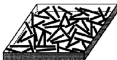
Slika 2.5 Primjer slobodno orijentiranih kratkih vlakana, [6]
