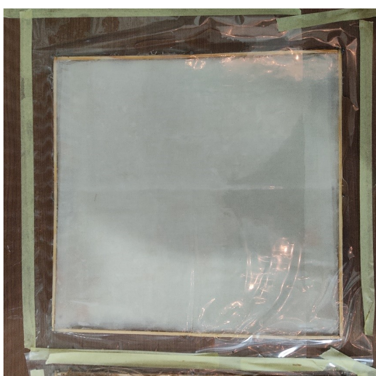
Slika 4.11 Završetak laminiranja i priprema sušenja
