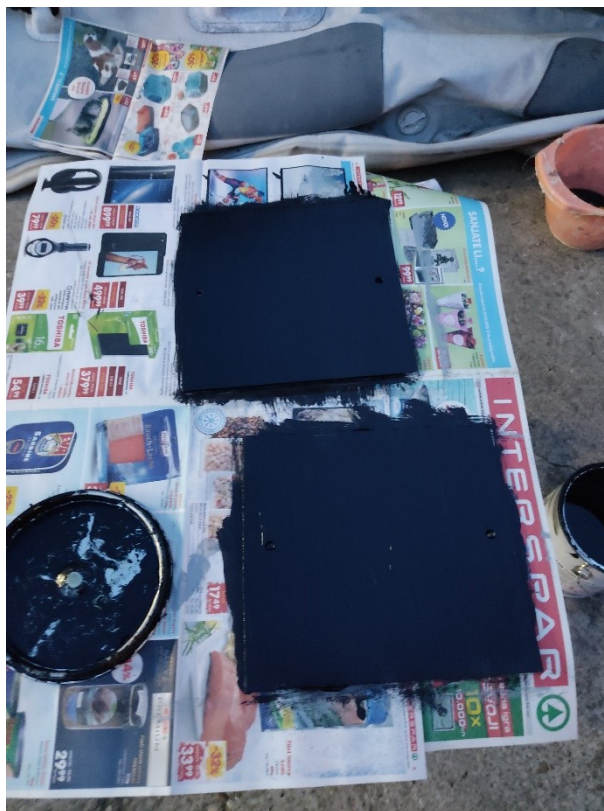
Slika 5.23 Test ploče nakon nanošenja premaza protiv obraštaja
