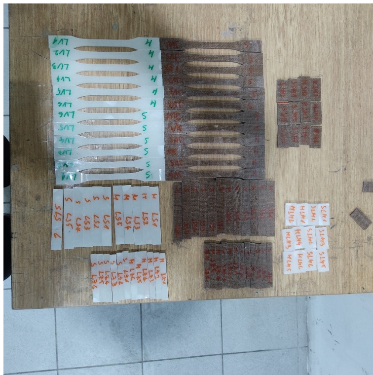
Slika 4.17 Epravete za ispitivanje mehaničkih svojstva
