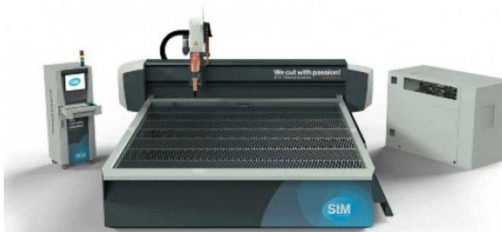
Slika 4.16 "Premium cut" stroj za rezanje vodenim mlazom
