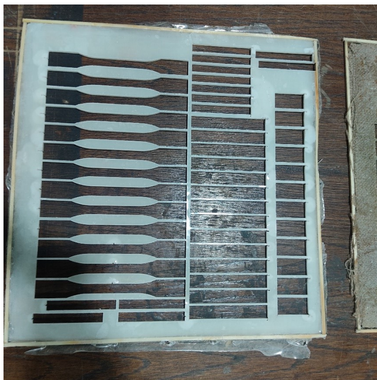
Slika 4.17 Epravete za ispitivanje mehaničkih svojstva
