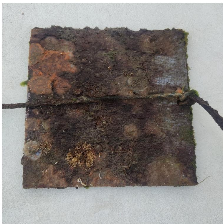
**Slika 5.25 Test ploča jute bez zaštitnog premaza nakon 180 dana.**
