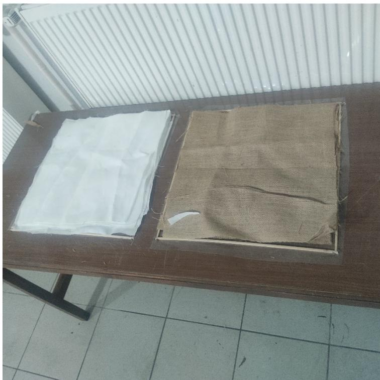
**Slika 4.10 Priprema vlakana za laminiranje**
