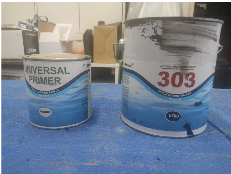
Slika 5.21 Temeljni premaz i premaz protiv obraštaja
