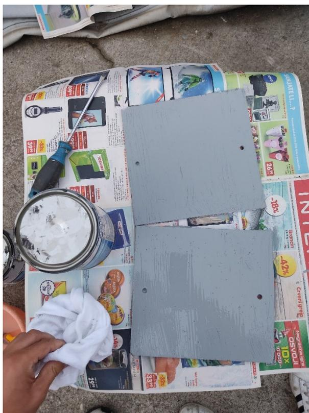
**Slika 5.22 Test ploče nakon nanošenja temeljnog premaza**
