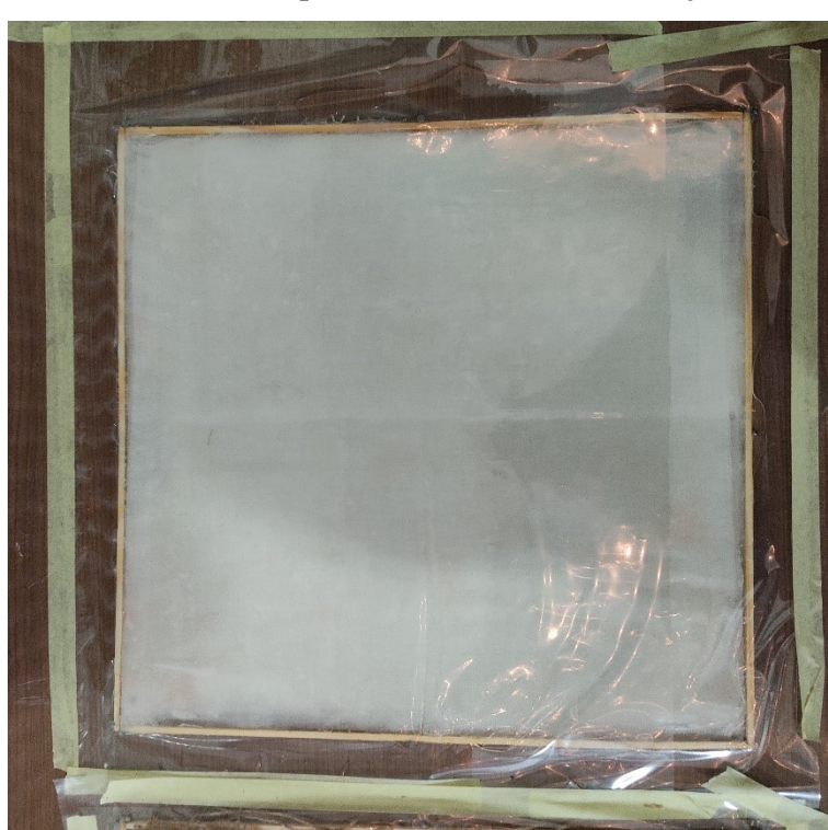
Slika 4.11 Završetak laminiranja i priprema sušenja
