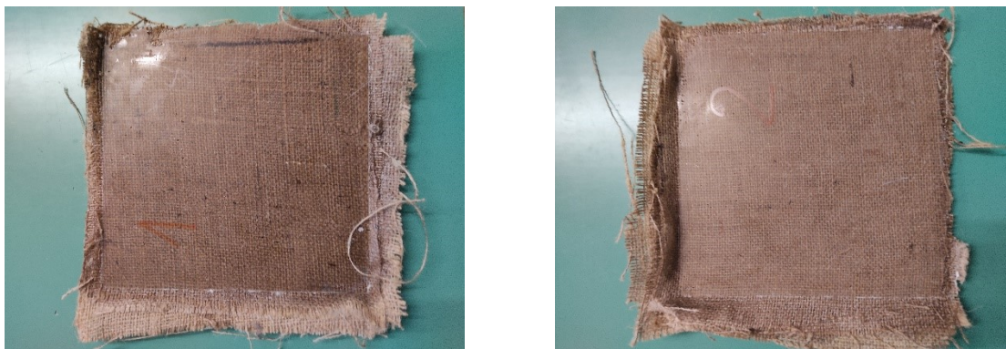
Slika 5.19 Ploče za ispitivanje otpornosti na obraštanje 1 i 2 (juta)
