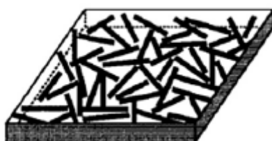
Slika 2.5 Primjer slobodno orijentiranih kratkih vlakana, [6]
