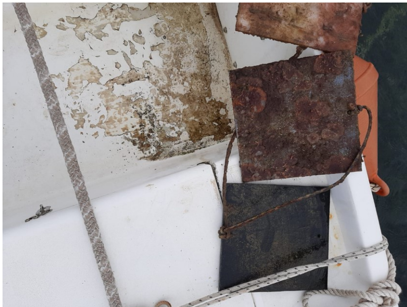
Slika 5.24 Test ploče nakon 120 dana
