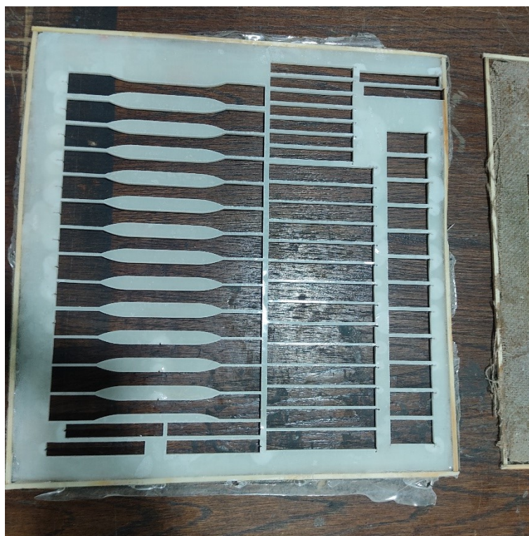
Slika 4.17 Epruvete za ispitivanje mehaničkih svojstva
