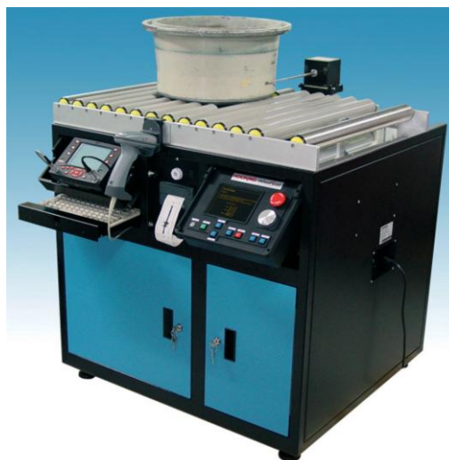
Slika 38: Automatizirani sustav za ispitivanje avionskog kotača [1]
