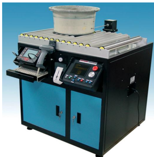
Slika 38: Automatizirani sustav za ispitivanje avionskog kotača [1]
