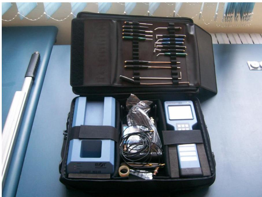
Slika 7: Tipičan komplet za ispitivanje vrtložnim strujama
