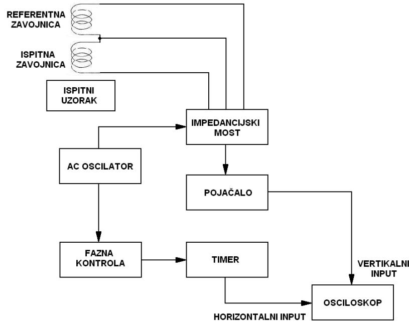
Slika 46: Blok dijagram uređaja za faznu analizu [5]
