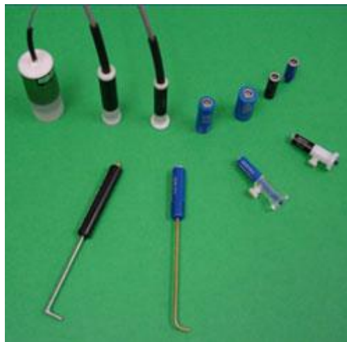
Slika 8: Nekoliko apsolutnih sondi [4]
