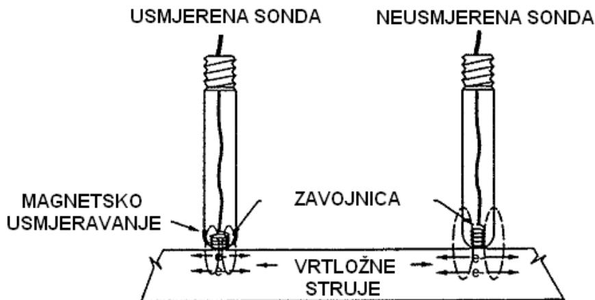
Slika 19: Usporedba usmjerene i neusmjerene sonde [5]
