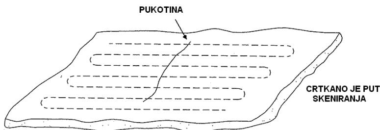
Slika 34: Skeniranje pukotina na ravnoj površini [3]
