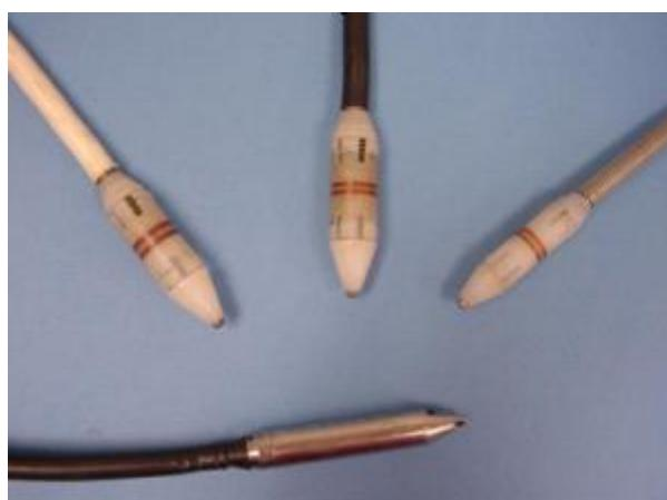
Slika 16: Sonde za unutarnje promjere [4]
