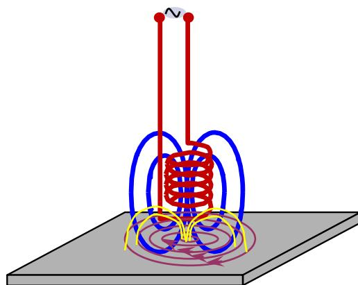
Slika 3: Magnetsko polje zavojnice i magnetsko polje vrtložnih struja [2]
