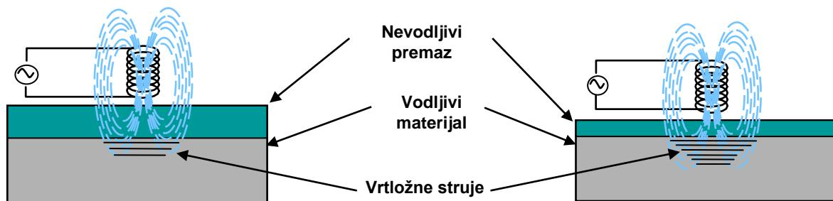
Slika 32: Mjerenje debljine nevodljivog premaza [2]
