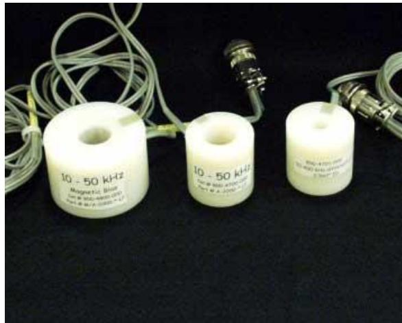
Slika 17: Sonde za vanjske promjere [2]
