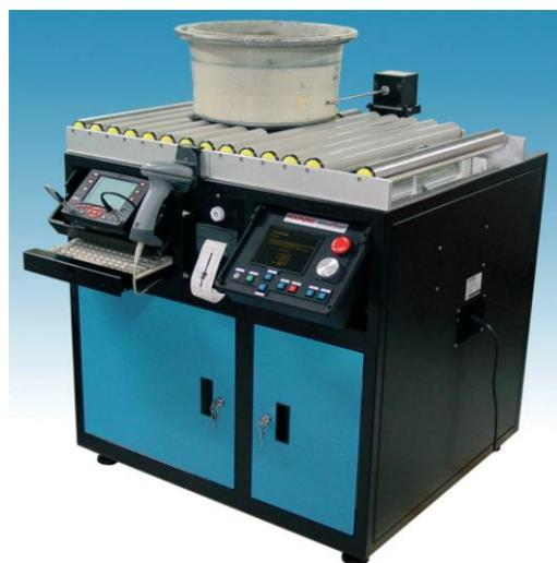
Slika 38: Automatizirani sustav za ispitivanje avionskog kotača [1]
