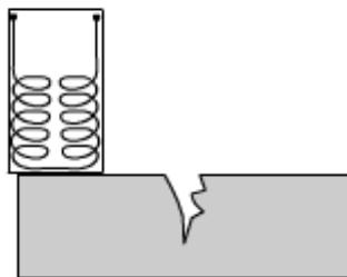
Slika 9: Diferencijalna sonda [4]
