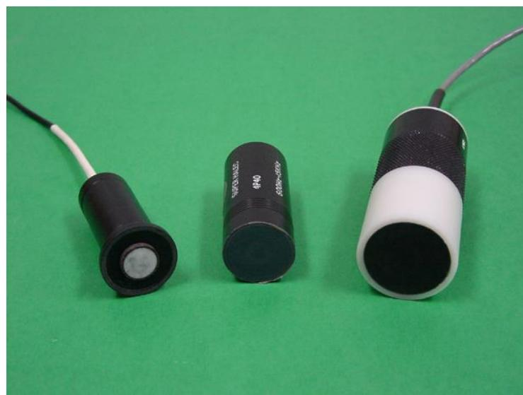
Slika 13: Niskofrekventne površinske sonde [4]
