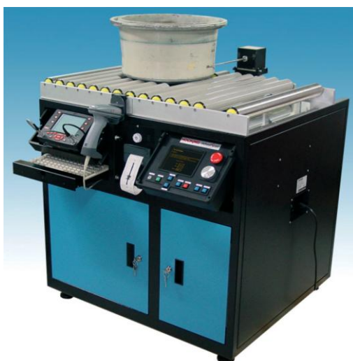
Slika 38: Automatizirani sustav za ispitivanje avionskog kotača [1]
