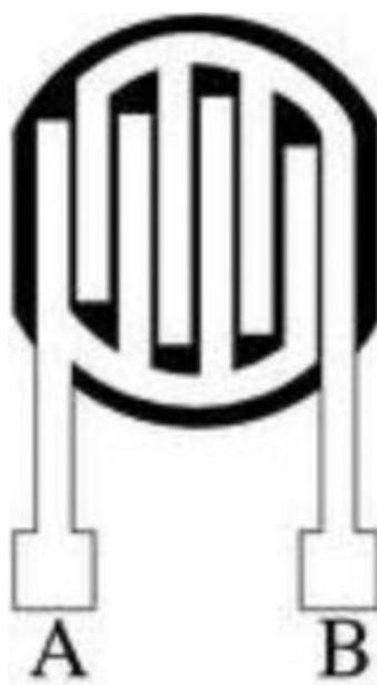
Slika 5. Shema rezistivnog senzora
