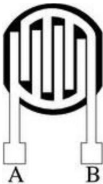
Slika 5. Shema rezistivnog senzora
