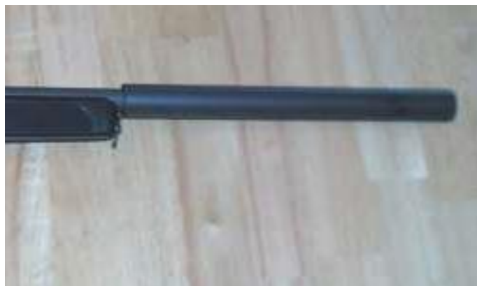
Slika 18. Moderator zvuka kao sastavni dio vatrene oružja [7]
