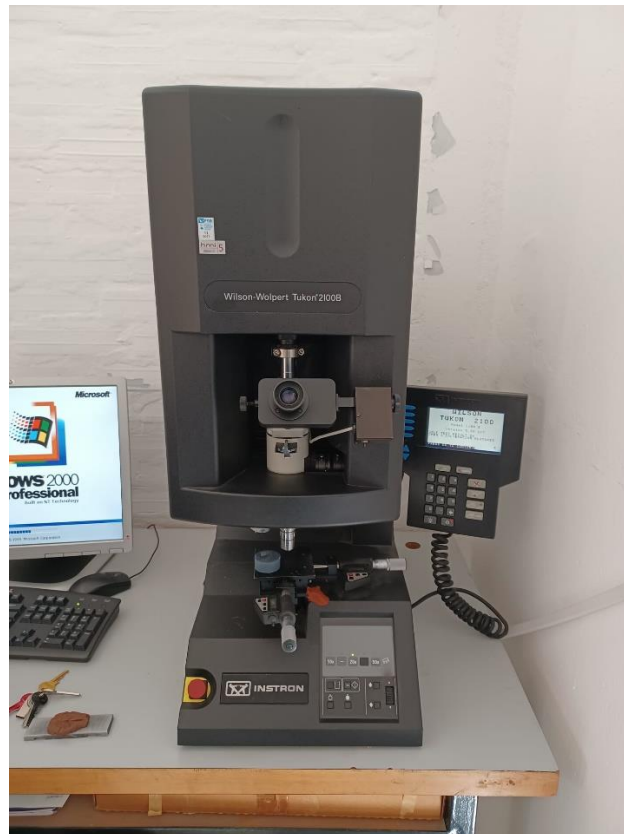
Slika 30. Vickers tvrdomjer Wolpert Wilson Tukon 2100B
