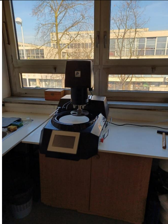
Slika 19. Uređaj za brušenje Mecatech 250
