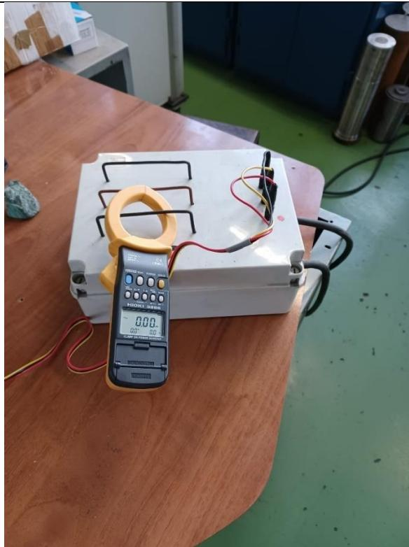
**Slika 16. Uređaj HIOKI 3286 za ispitivanje snage stroja**
