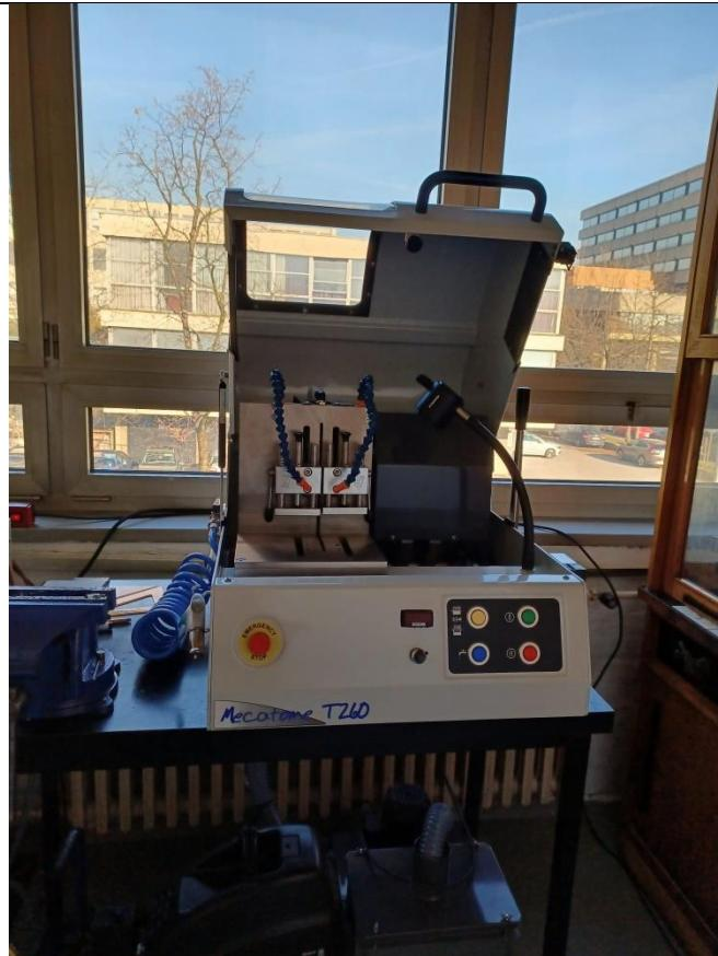
Slika 17. Pila Mecatome T260
