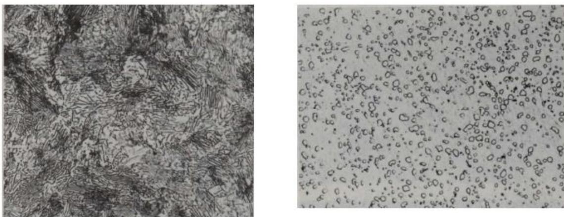
**Slika 5. Mikrostruktura 50CrMoV4 prije i poslije sferoidizacijskog žarenja [3]**
