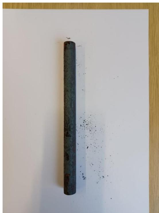
Slika 13. Žareni uzorak nakon ohlađivanja
