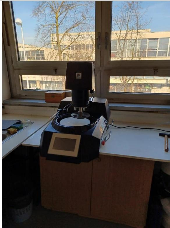
**Slika 19. Uređaj za brušenje Mecatech 250**
