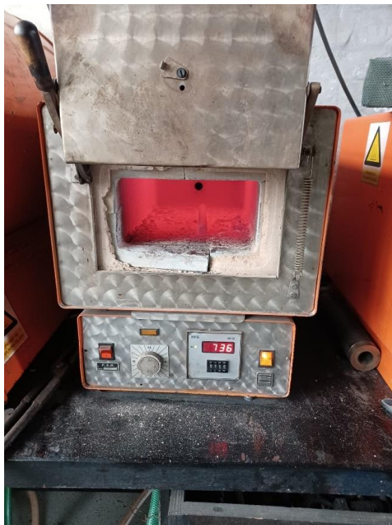
Slika 12. Uzorak u komornoj peći zagrijan na temperaturu za žarenje
