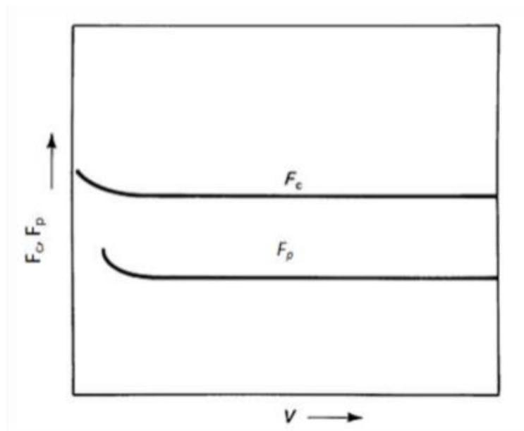
Slika 9. Ovisnost sile rezanja o glavnoj brzini [11]
