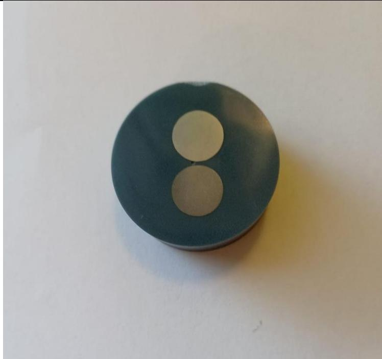
**Slika 18. Izrezani uzorci u polimernoj masi**
