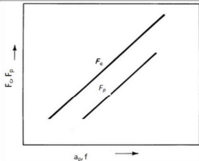
Slika 8. Ovisnost sile rezanja o dubini rezanja i posmaku [11]
