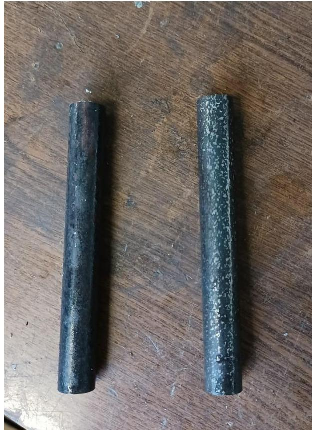
Slika 14. Žareni uzorak (lijevo) i nežareni uzorak (desno)
