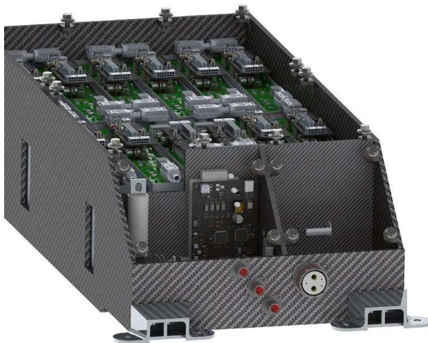
Slika 13. FS NTNU 2019 baterijski paket [14]
