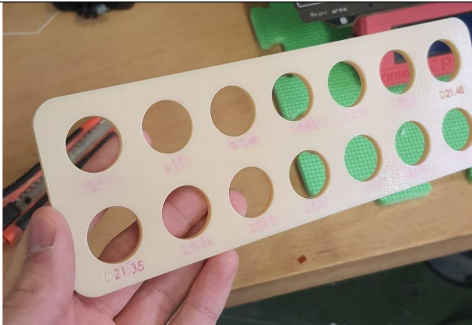
Slika 66. Testni držač ćelija s različitim dimenzijama provrta
