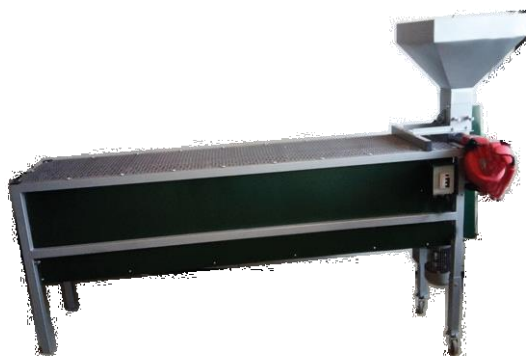
Slika 10. Getreide drobilica za lješnjake i orahe
