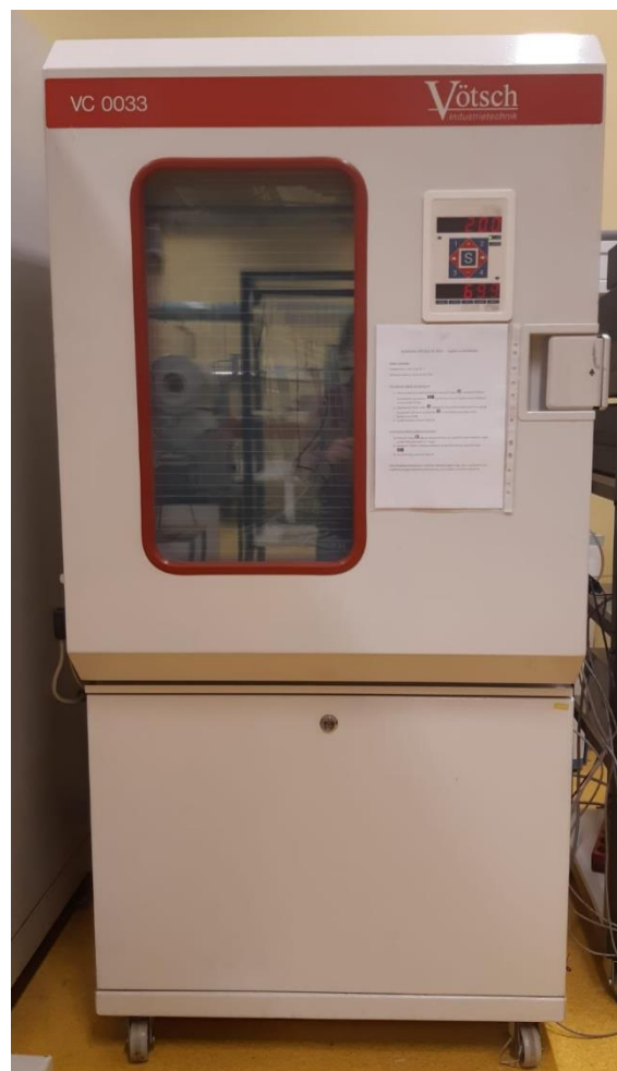
Slika 7. Klimatska komora Vötsch HC 0033
