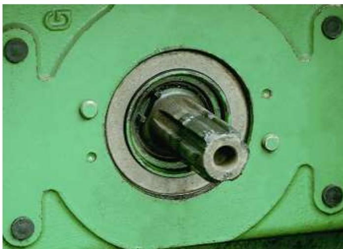
**Slika 5. Izlazno vratilo traktora**
