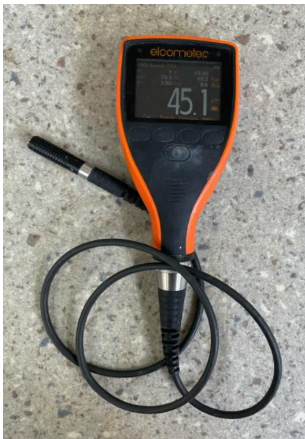
Slika 13. Uređaj za mjerenje debljine „Elcometer 456“
