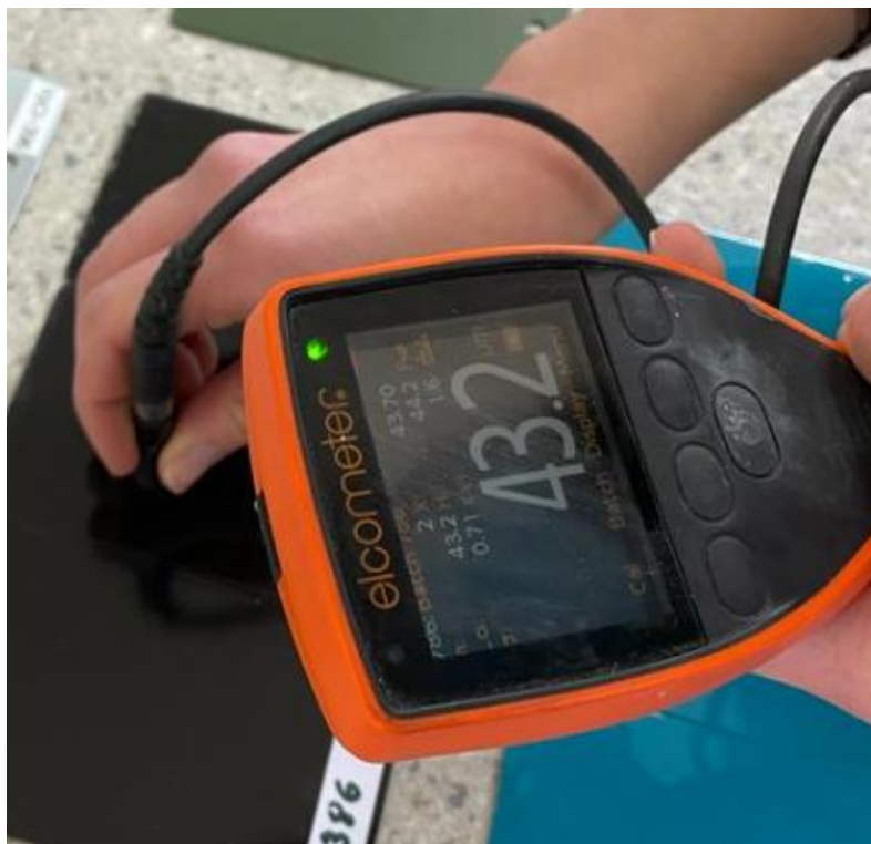
Slika 14. Način mjerenja debljine
