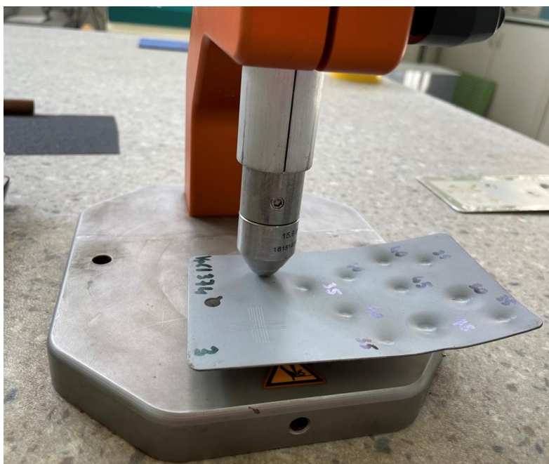
Slika 20. Ispitivanje otpornosti premaza na udar
