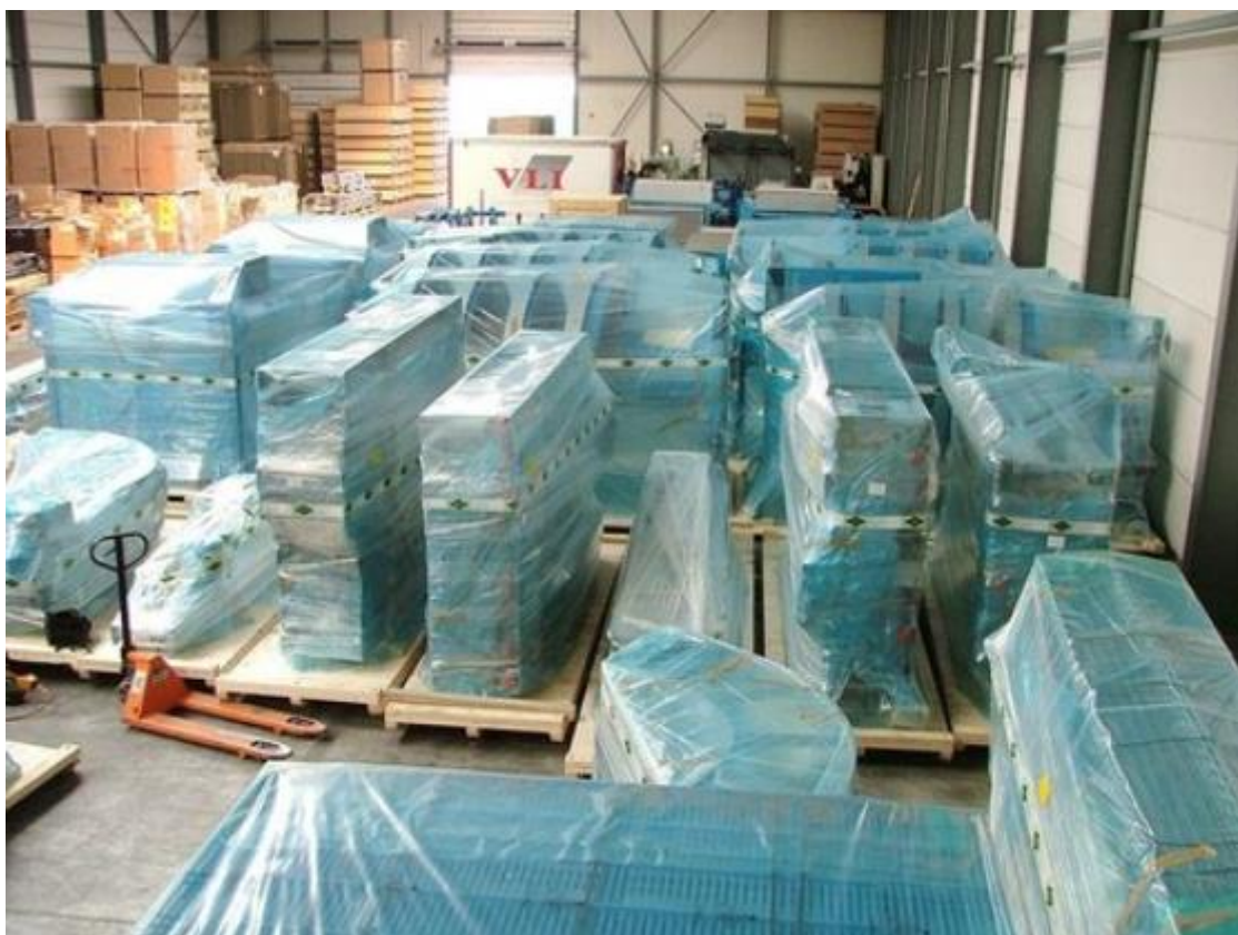
Slika 9. Skladištenje elemenata zaštitnom folijom s inhibitorima korozije [17]
