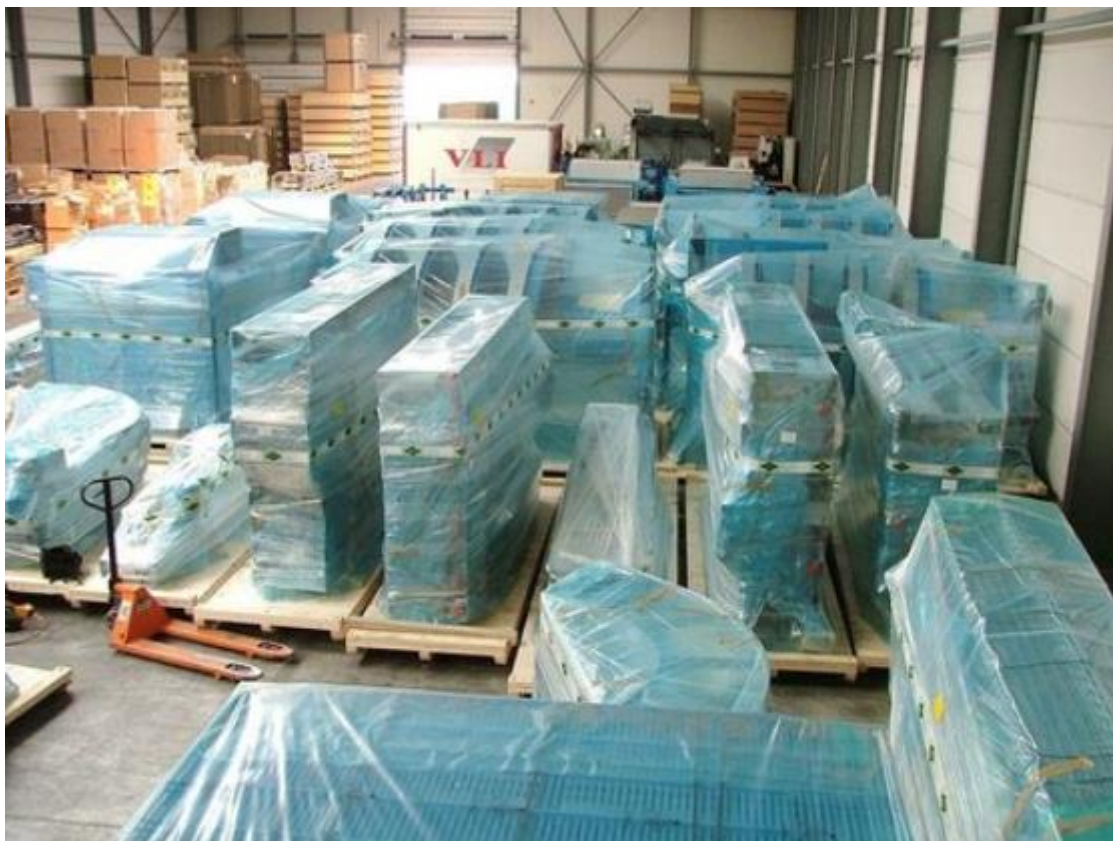
Slika 9. Skladištenje elemenata zaštitnom folijom s inhibitorima korozije [17]
