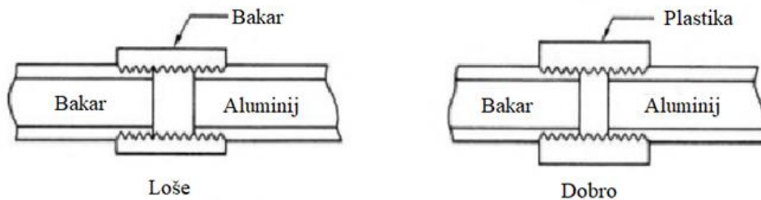
Slika 3. Primjer sprječavanja galvanske korozije [5]
