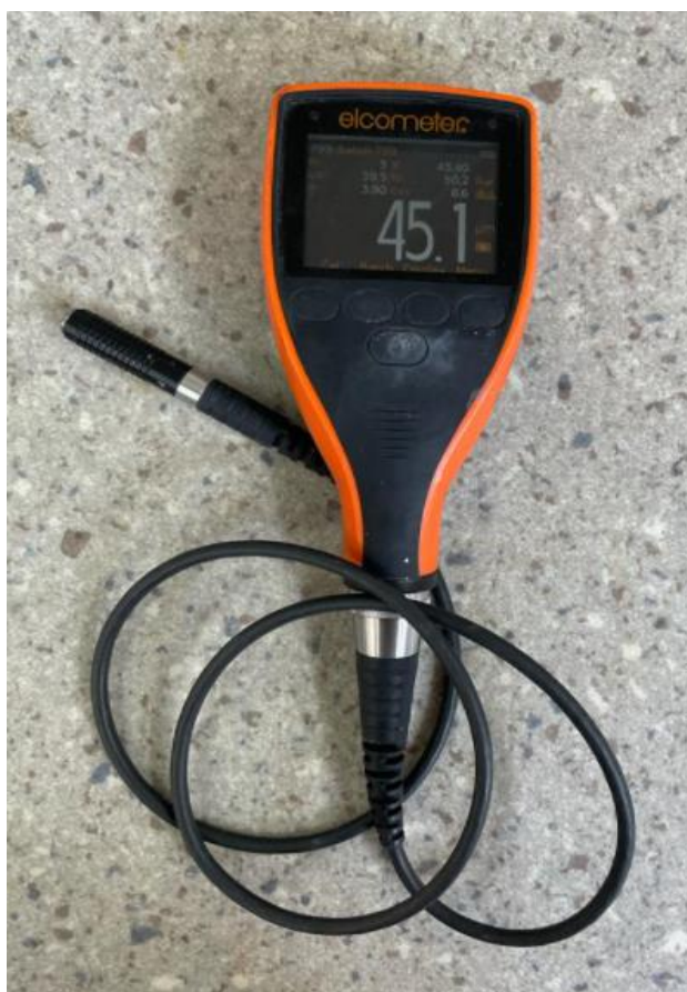
Slika 13. Uređaj za mjerenje debljine „Elcometer 456“
