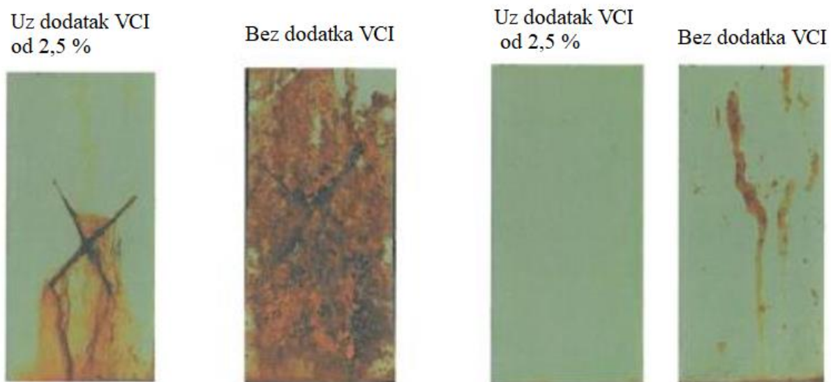
Slika 12. Učinkovitost premaza s hlapivim inhibitorima korozije [20]
