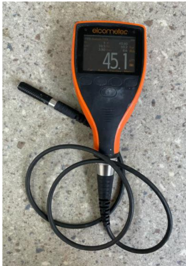
Slika 13. Uređaj za mjerenje debljine „Elcometer 456“
