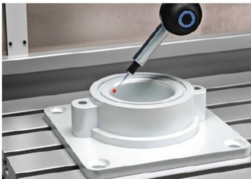
Slika 74. CMM kontrola lokacije provrta [1]
