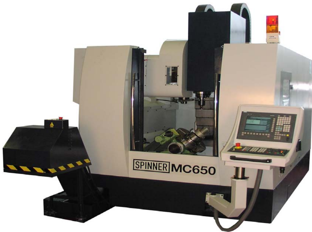
Slika 10. Vertikalni glodači obradni centar [5].
