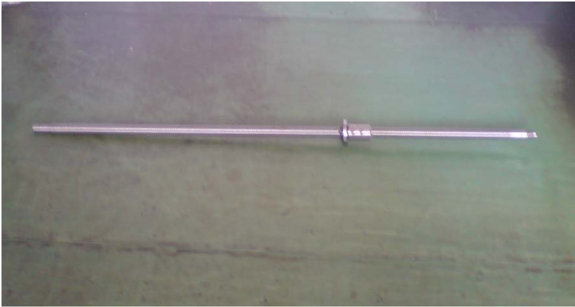
Slika 33. Kuglično navojno vreteno s dvodijelnom maticom
