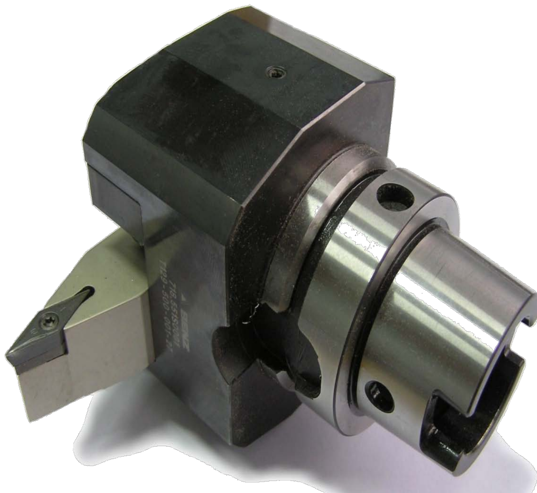
Slika 19. HSK držač tokarskoga noža za višenamjenske obradne sustave [11].
