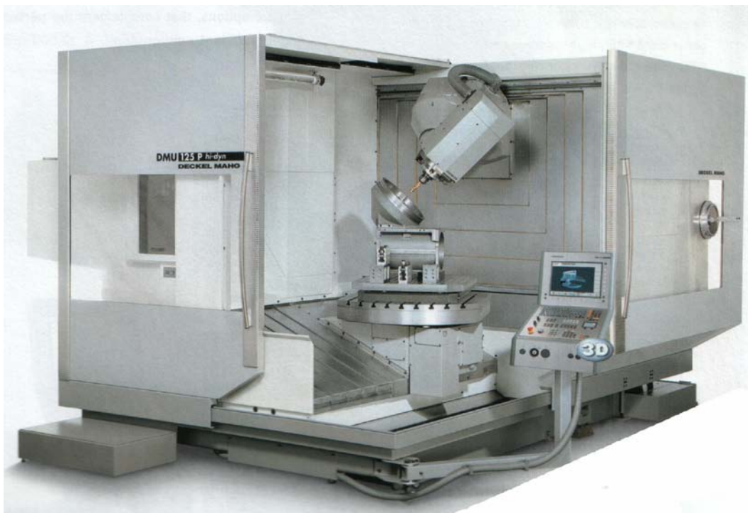
Slika 11. Horizontalno/vertikalni glodači obradni centar [6].
