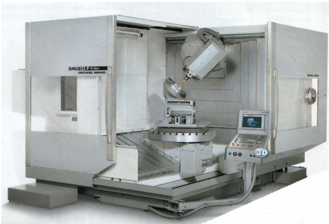
Slika 11. Horizontalno/vertikalni glodači obradni centar [6].
