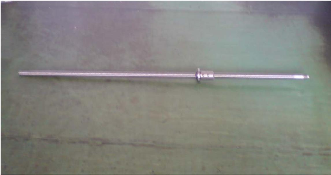
Slika 33. Kuglično navojno vreteno s dvodijelnom maticom
