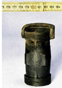
Slika 2. Galvanska (bimetalna) korozija [5]
