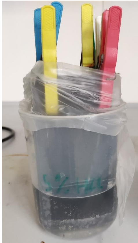
Slika 65. Uzorci uronjeni u 5 %-tnu HCl
