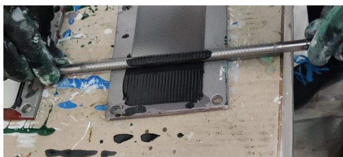
Slika 33. Nanošenje premaza spiralnim aplikatorom
