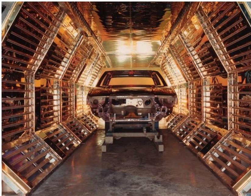
Slika 22. Električno IC sušenje u autoindustriji [24]
