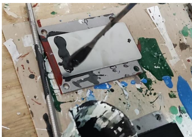
Slika 32. Prijenos premaza žlicom na uzorak
