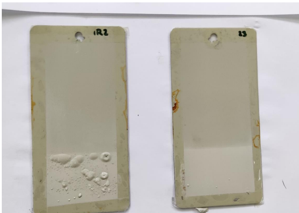
Slika 66. Uzorci nakon 48 sati izlaganja klorovodičnoj kiselinu - Hempadur 15553
