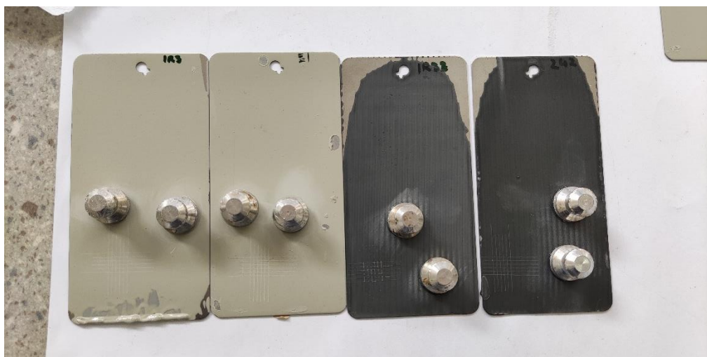
Slika 39. Čunjići zalijepljeni na ispitne uzorke
