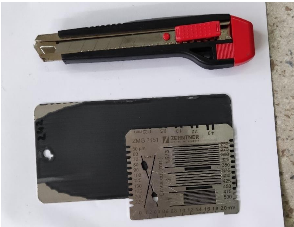
Slika 41. Izgled etalona za urezivanje cross-cut metodom
