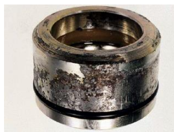
Slika 3. Korozija u procjepu [5]
