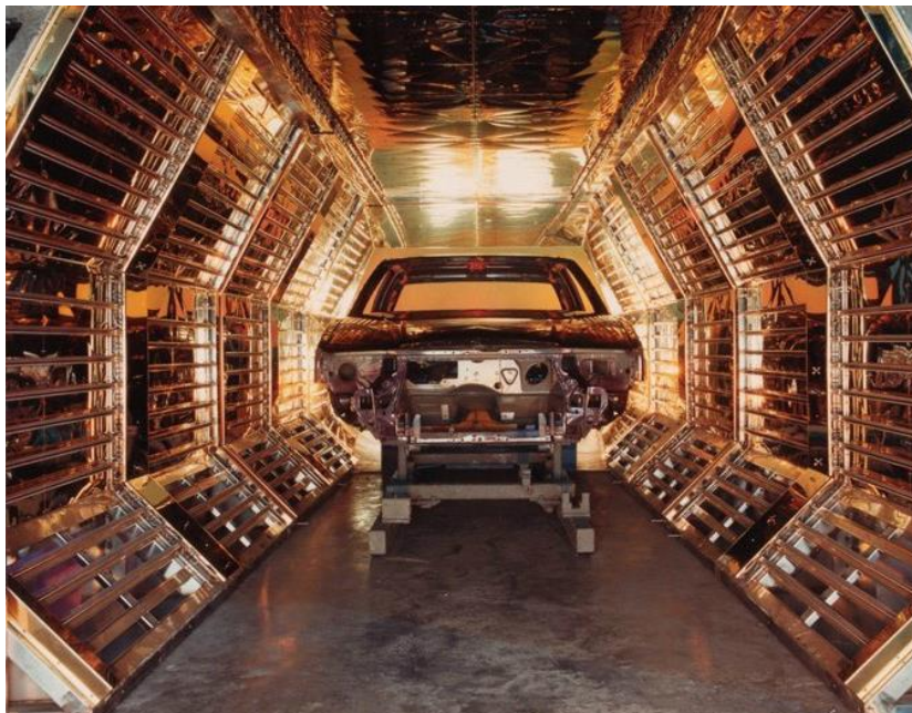
Slika 22. Električno IC sušenje u autoindustriji [24]
