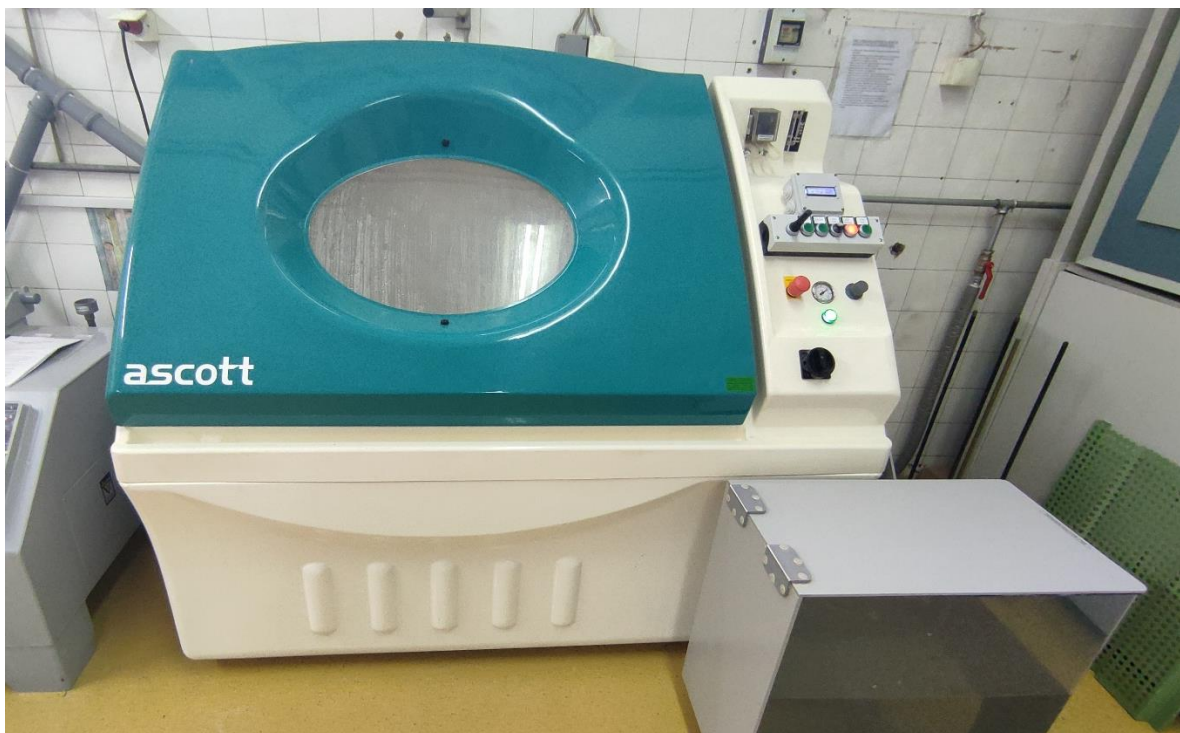
Slika 56. Slana komora Ascott S450
