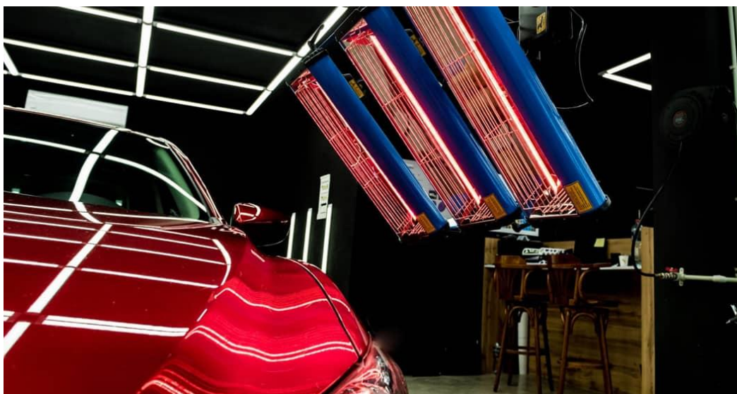
Slika 23. IC sušenje premaza automobila [26]
