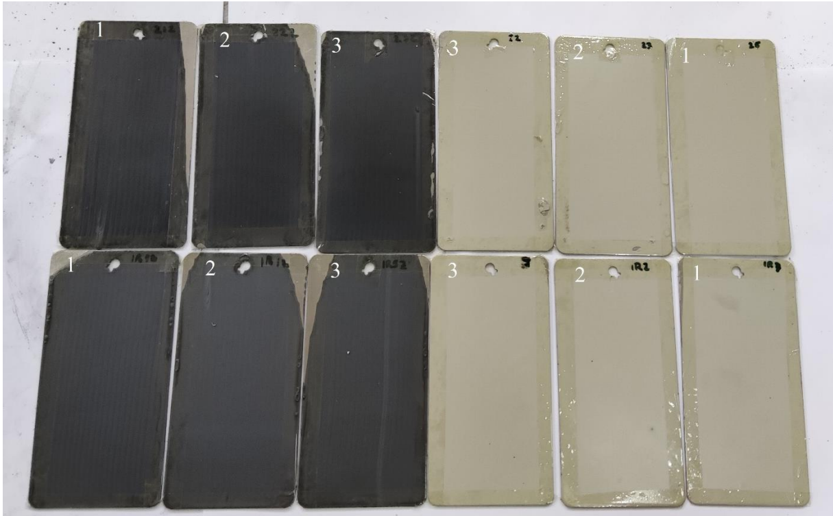
Slika 62. Uzorci pripremljeni za uranjanje u kiseline
