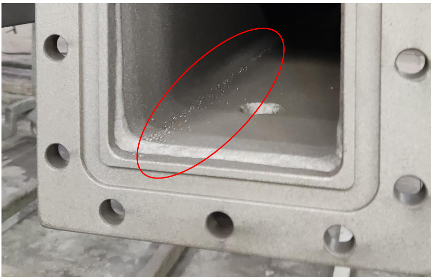
Slika 28. Nepravilnosti na površini
