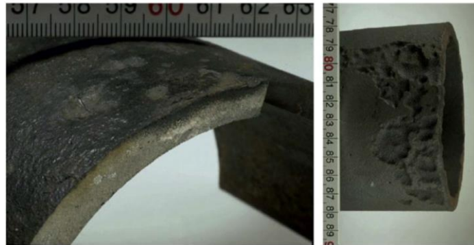
Slika 6. Selektivna korozija – grafitizacija [5]
