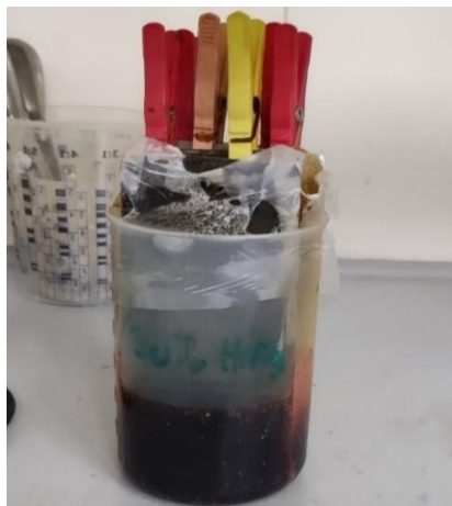
Slika 63. Uzorci uronjeni u vodenu otopinu dušične kiseline
