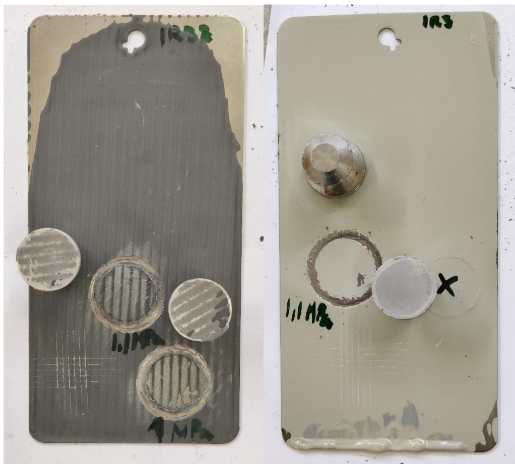
Slika 40. Izgled uzoraka nakon odvajanja čunjića
