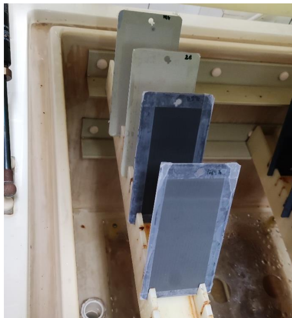
Slika 59. Uzorci u vlažnoj komori 1. dan
