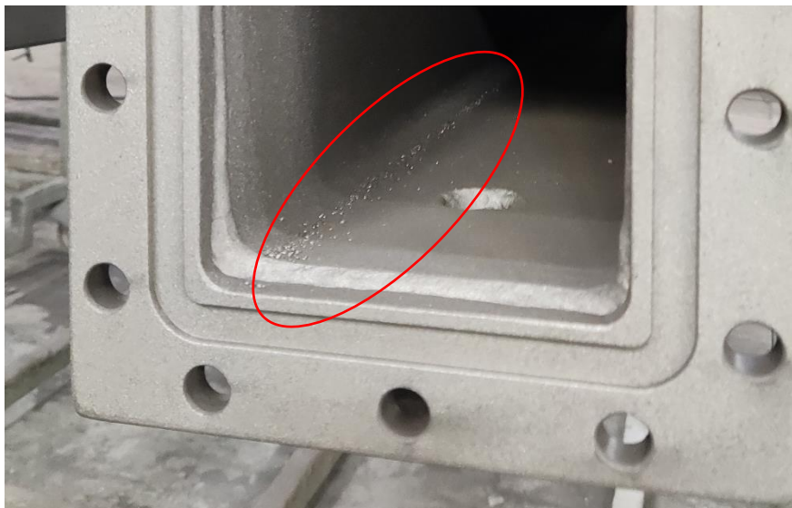
Slika 28. Nepravilnosti na površini
