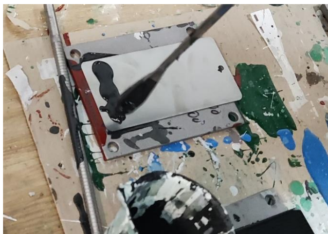
Slika 32. Prijenos premaza žlicom na uzorak
