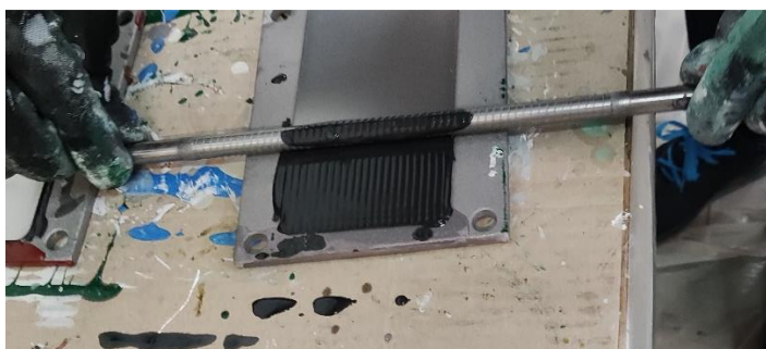
Slika 33. Nanošenje premaza spiralnim aplikatorom
