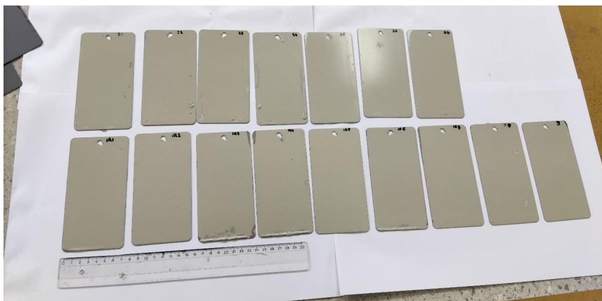
Slika 36. Uzorci premaza Hempadur 15553
