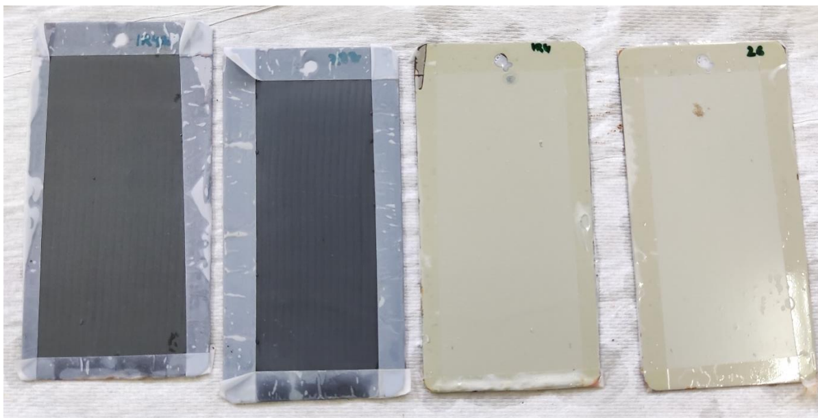
Slika 60. Uzorci izloženi u vlažnoj komori 3.dan
