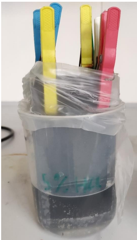
Slika 65. Uzorci uronjeni u 5 %-tnu HCl
