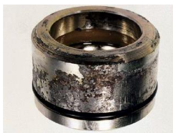
Slika 3. Korozija u procjepu [5]
