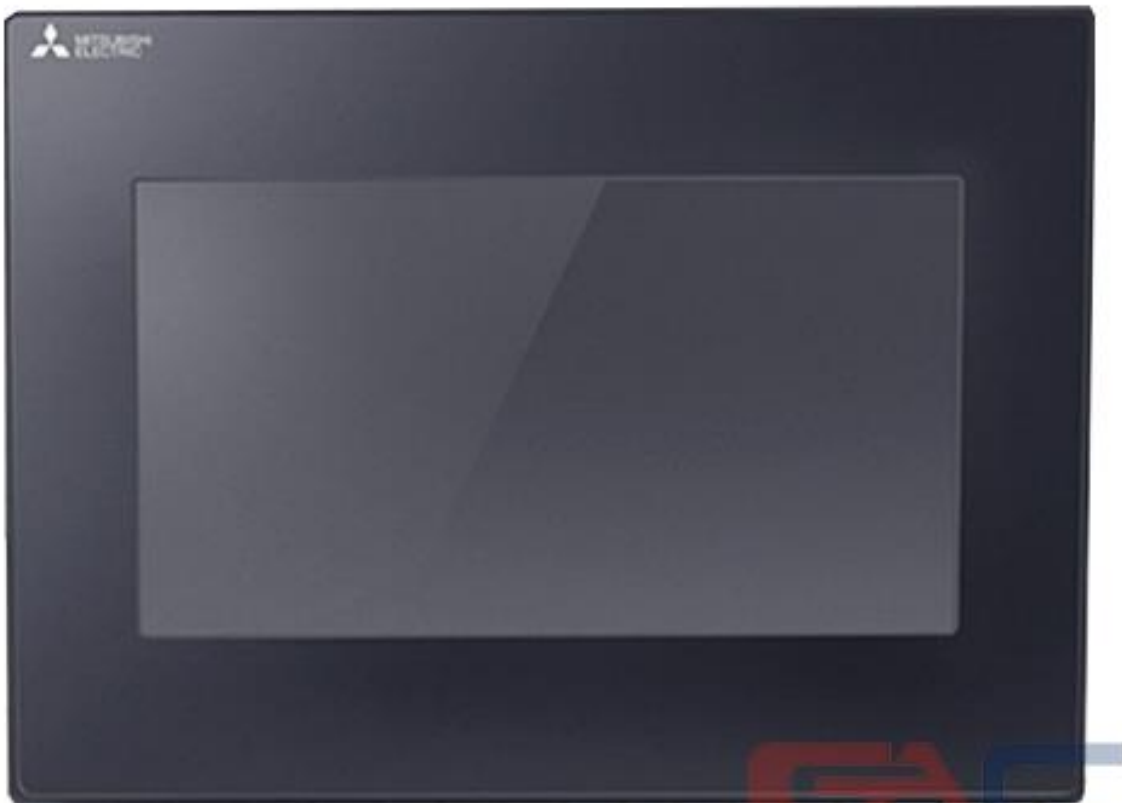
Slika 15. HMI uređaj (grafičko sučelje prema korisniku)
