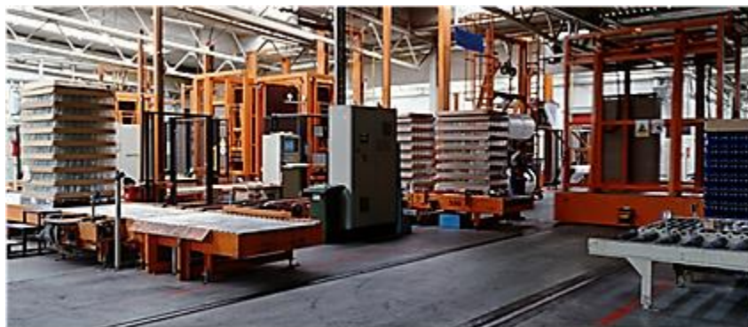
Slika 11. Paletizacija gotovih proizvoda
