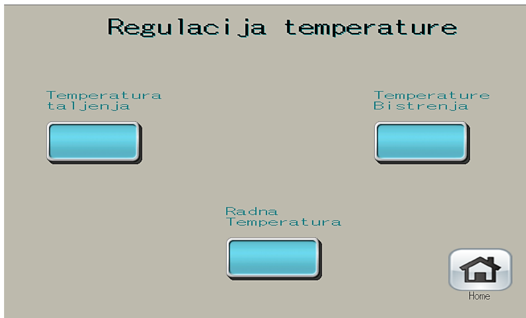
Slika 45. Izbornik regulacije temperatura
