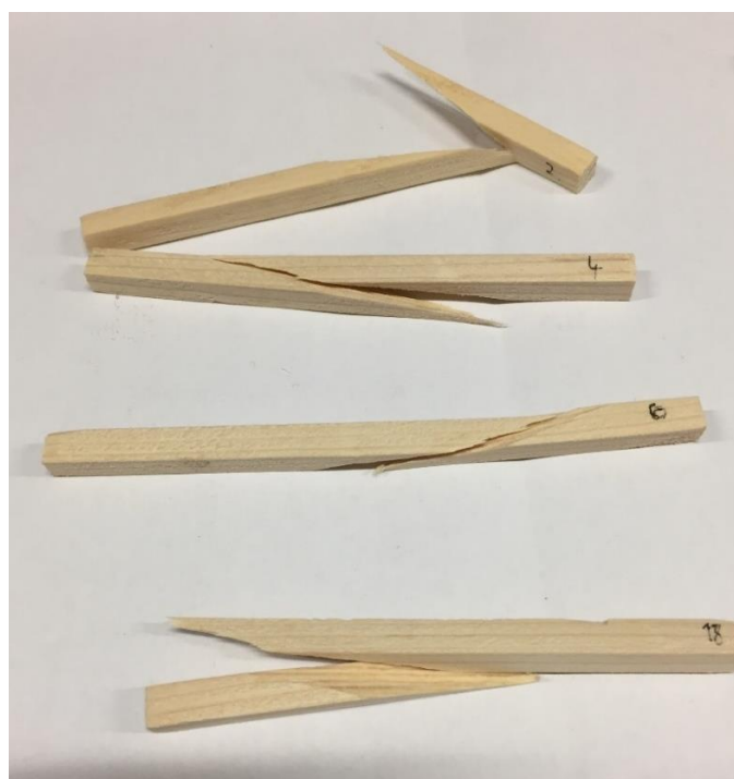
Slika 23 Karakterističan izgled lomova na ispitnim uzorcima L45 (45°)
