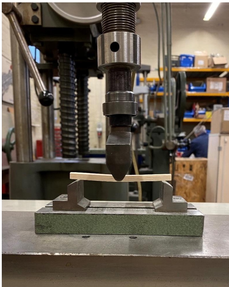
Slika 19 Savijanje ispitnog uzorka na kidalici
