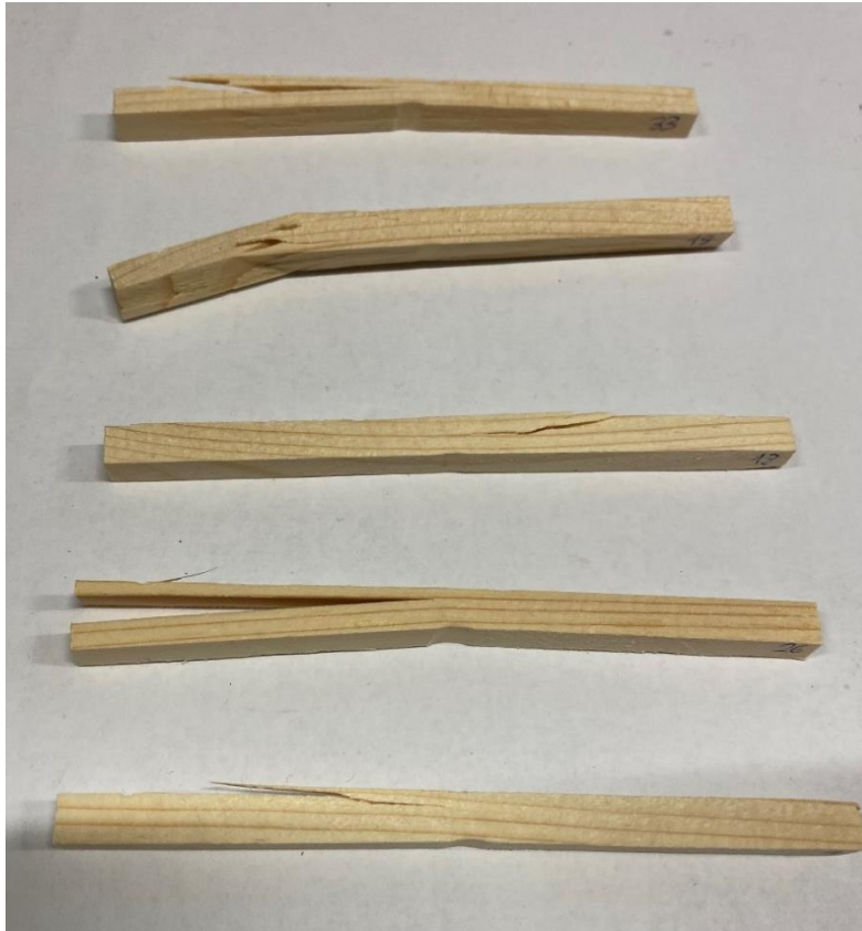
Slika 25 Karakterističan izgled lomova na ispitnim uzorcima L90 (90°)
