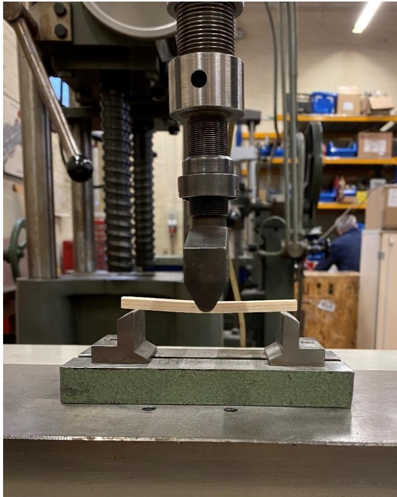
Slika 19 Savijanje ispitnog uzorka na kidalici
