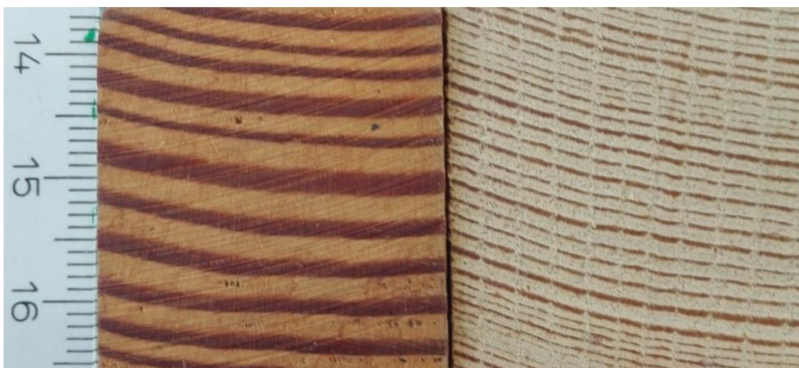
Slika 6 Razlika u širini godova na poprečnom presjeku ariša
