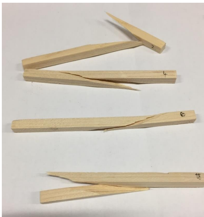
Slika 23 Karakterističan izgled lomova na ispitnim uzorcima L45 (45°)
