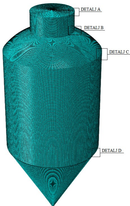
Slika 66. Model spremnika sa definiranom mrežom konačnih elemenata
