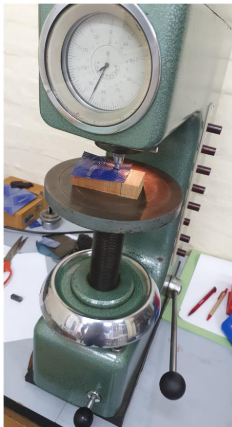
Slika 4.11 Tvrdomjer VEB WPM HP 250
