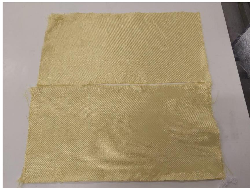
*Slika 24. Aramidna vlakna korištena u izradi kompozitnih ploča*
