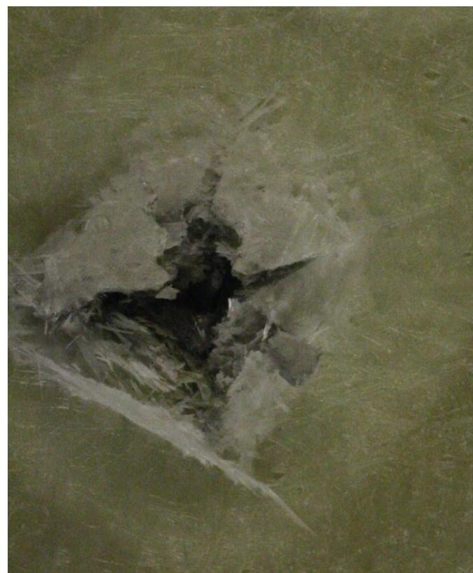
Slika 30. Izlaz metka kalibra ".357" iz kompozitne ploče
