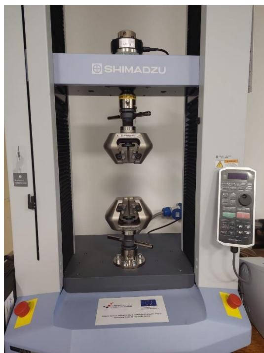
Slika 33. Shimadzu uređaj korišten za savojno ispitivanje
