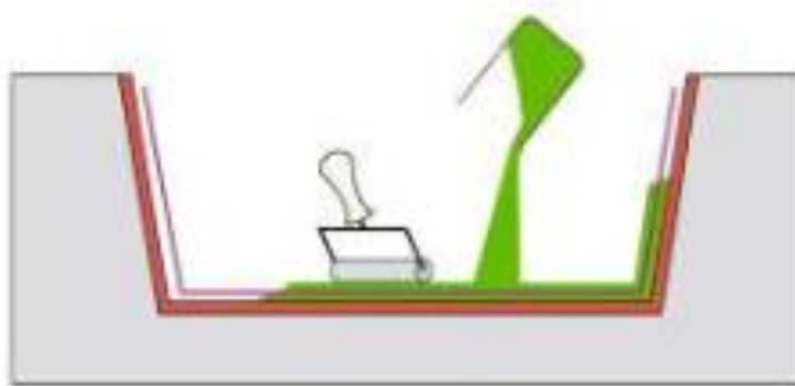
Slika 15. Postupak izrade kompozita ručnim polaganjem [3]
