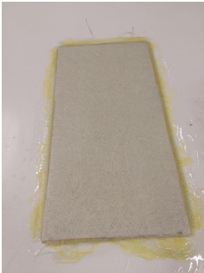
*Slika 26. Kompozitna ploča nakon završetka postupka ručnog polaganja*
