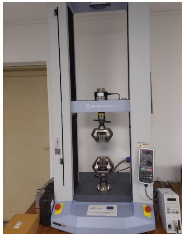
Slika 35. Shimadzu uređaj korišten za vlačno ispitivanje
