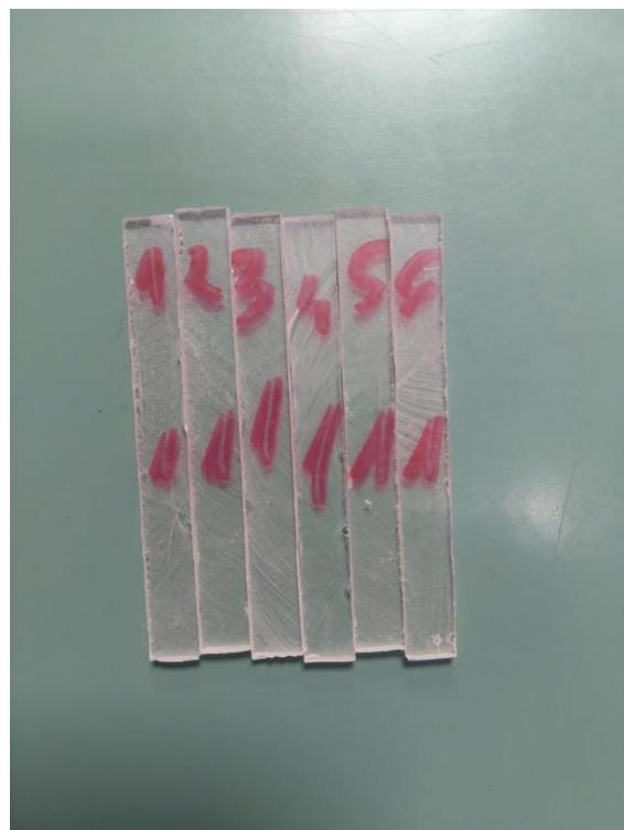
*Slika 37. Epruvete izrađene od epoksidne smole bez ojačala koje se podvrgavaju ispitivanju udarnog rada loma*
