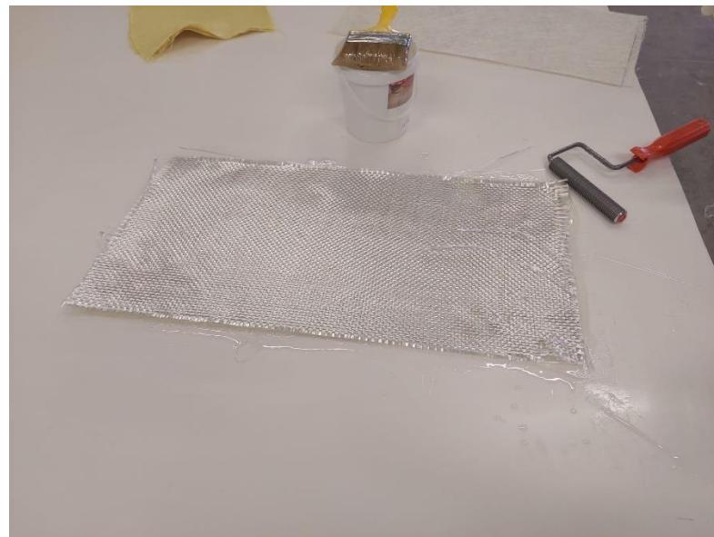
*Slika 23. Rowing tkanje spremno za impregniranje smolom*
