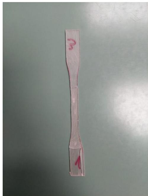
Slika 36. Epruveta nakon vlačnog ispitivanja
