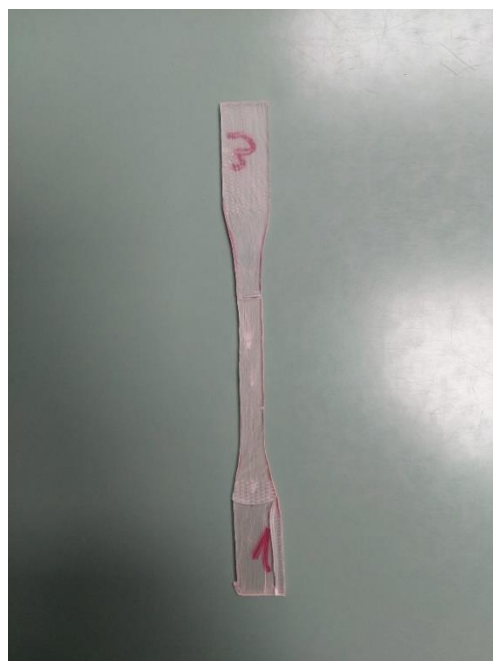
Slika 36. Epruveta nakon vlačnog ispitivanja
