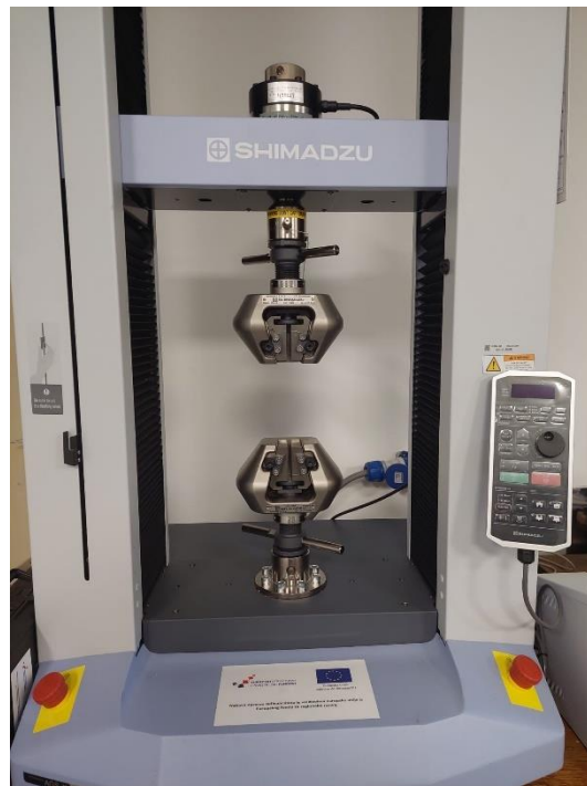
Slika 33. Shimadzu uređaj korišten za savojno ispitivanje
