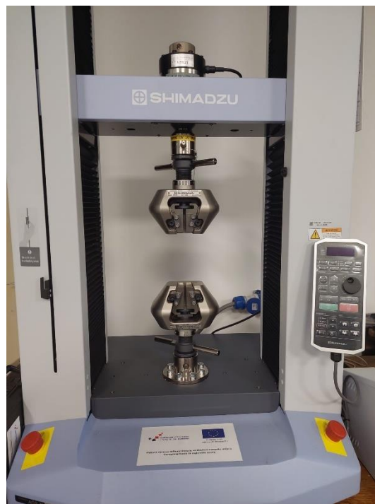
Slika 33. Shimadzu uređaj korišten za savojno ispitivanje
