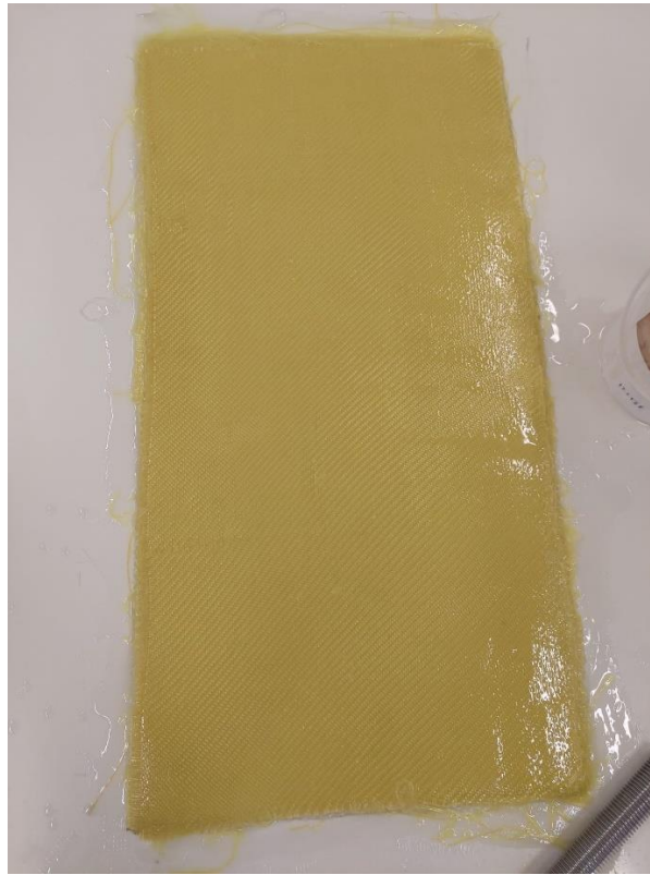
Slika 25. Aramidna vlakna natopljena smolom
