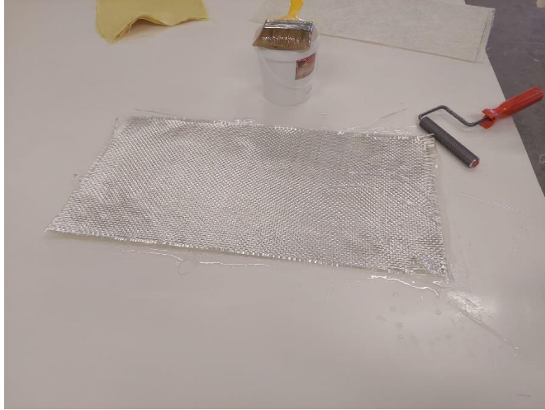
Slika 23. Rowing tkanje spremno za impregniranje smolom
