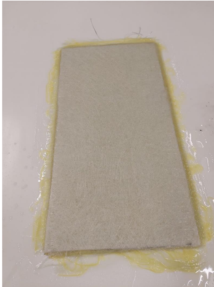
Slika 26. Kompozitna ploča nakon završetka postupka ručnog polaganja
