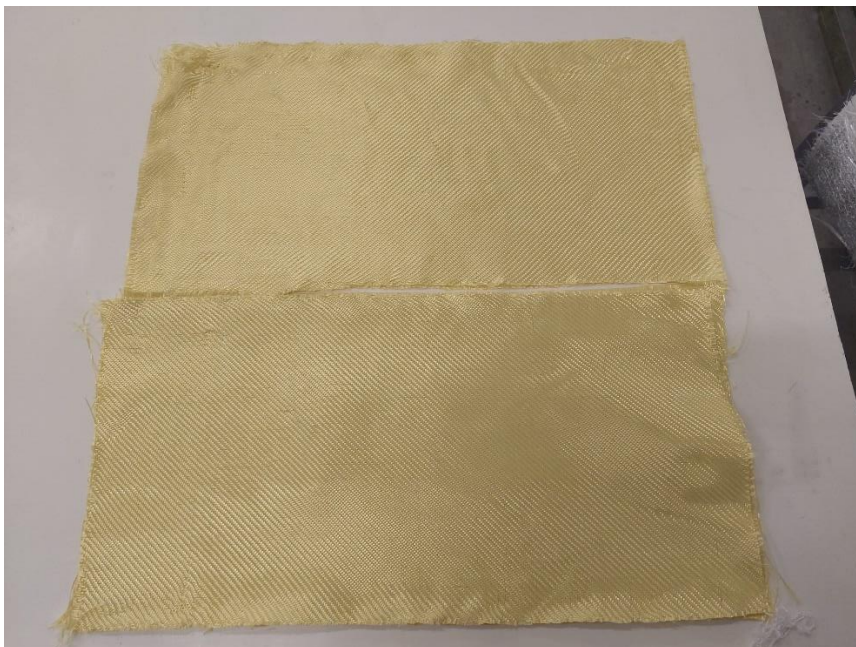
Slika 24. Aramidna vlakna korištena u izradi kompozitnih ploča
