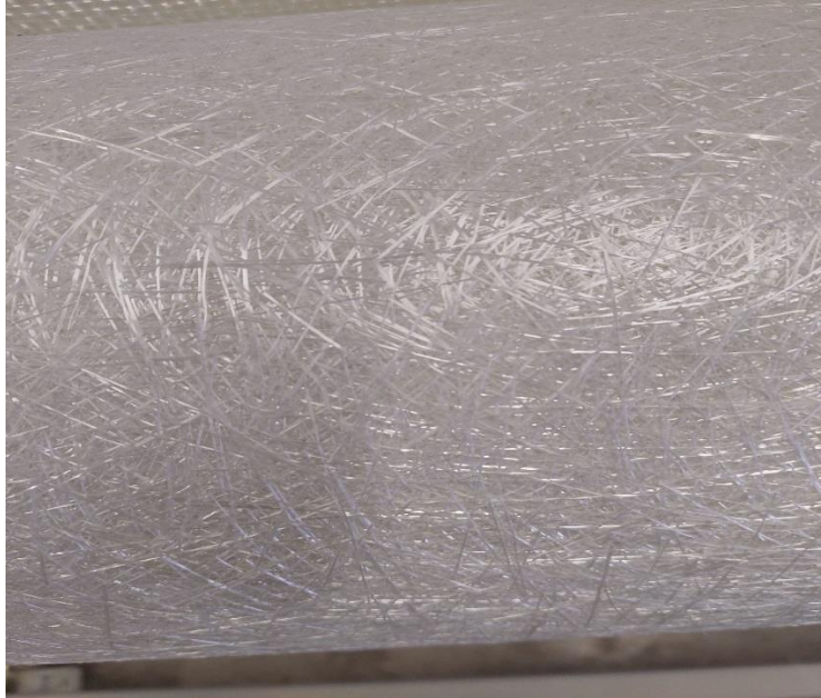
Slika 5. Prikaz mat vlakana (vlastita fotografija)
