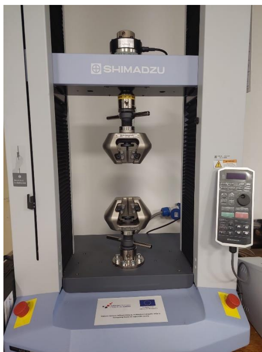
Slika 33. Shimadzu uređaj korišten za savojno ispitivanje
