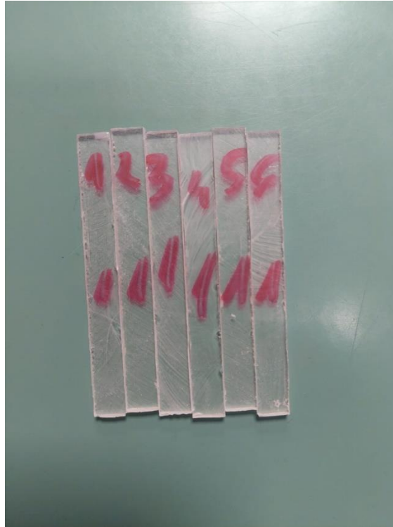
Slika 37. Epruvete izrađene od epoksidne smole bez ojačala koje se podvrgavaju ispitivanja udarnog rada loma
