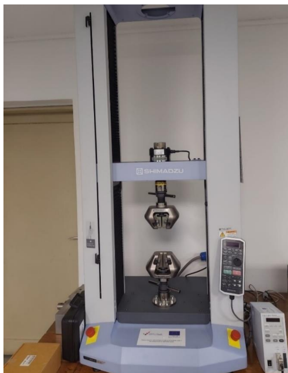
Slika 35. Shimadzu uređaj korišten za vlačno ispitivanje
