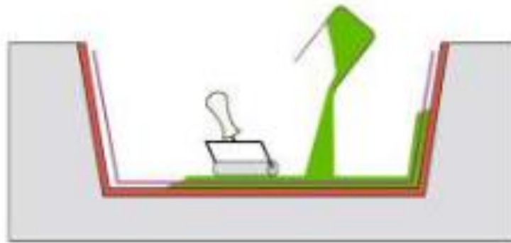
Slika 15. Postupak izrade kompozita ručnim polaganjem [3]
