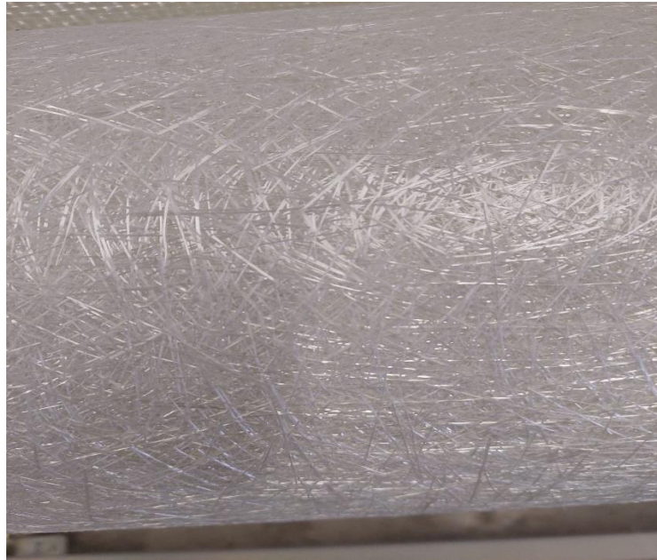
Slika 5. Prikaz mat vlakana (vlastita fotografija)
