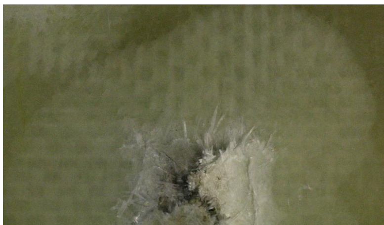
Slika 28. Izlaz metka kalibra ".44 Magnum" iz kompozitne ploče
