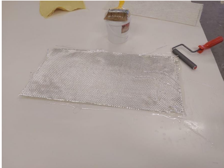
Slika 23. Rowing tkanje spremno za impregniranje smolom
