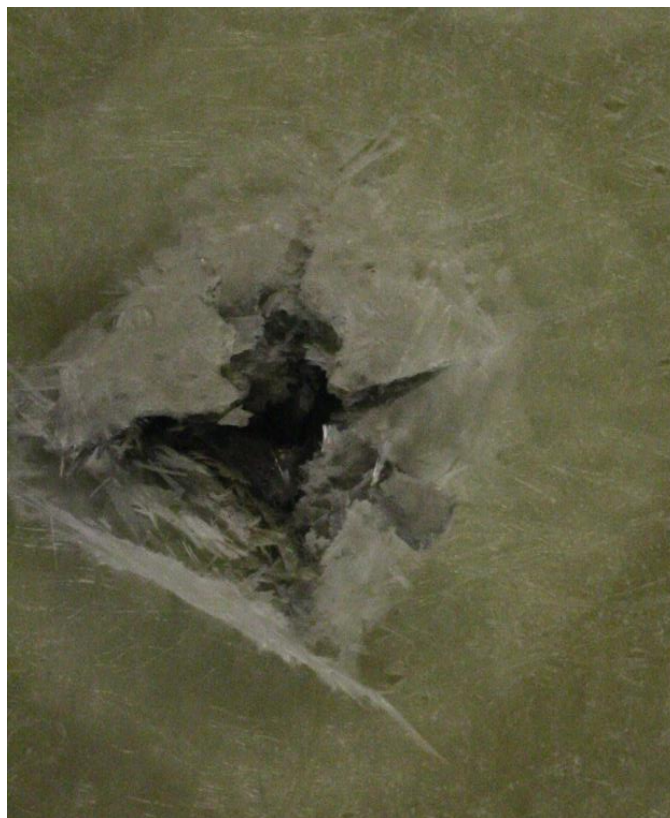
Slika 30. Izlaz metka kalibra ".357" iz kompozitne ploče
