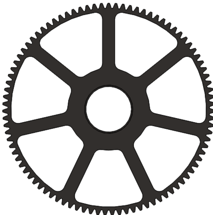
Slika 32. CAD model zupčanika olakšanog obradom odvajanjem čestica.
