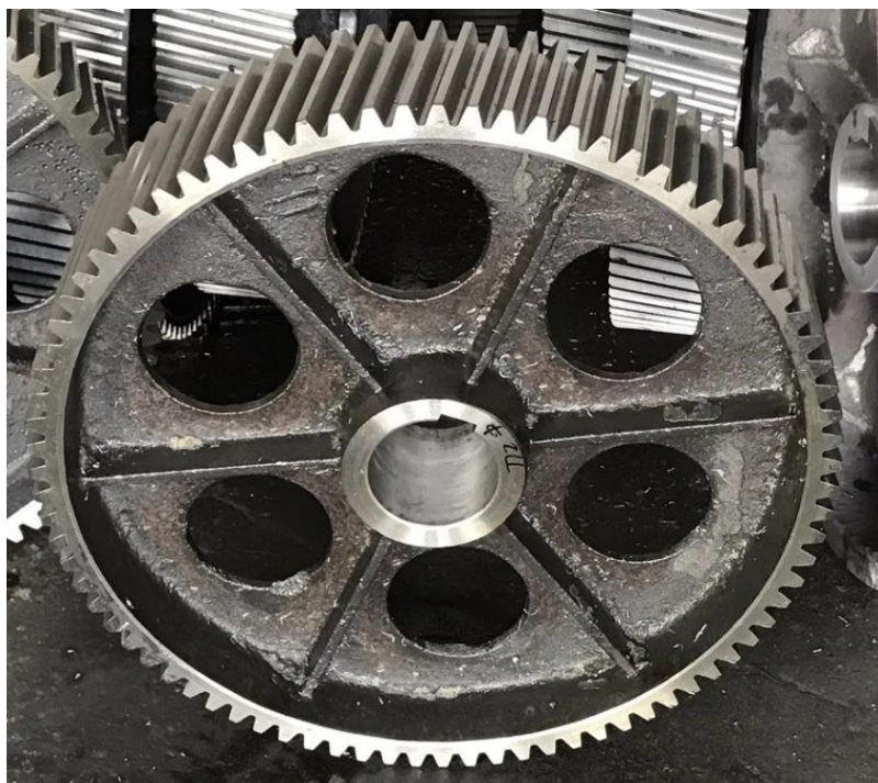
Slika 10. Primjer sličan zavarenom zupčaniku 2 iz prakse, ali s kosim zubima [8].
