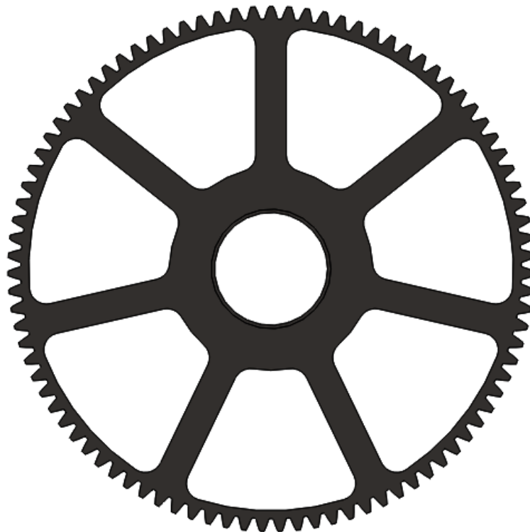
Slika 32. CAD model zupčanika olakšanog obradom odvajanjem čestica.
