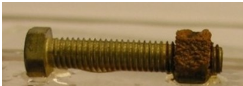
Slika 7. Galvanska korozija mjedi i čelika [14]
