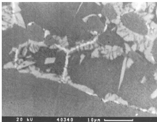
Slika 20. Mikrostruktura dupleks čelika sa chi-fazom [20]
