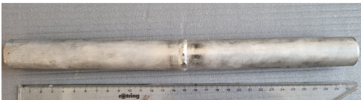
Slika 28. Zavarena cijev čelika X2CrNiMoN 25-7-4
