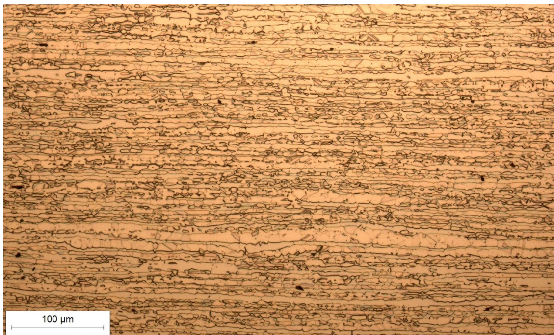
Slika 37. Mikrostruktura osnovnog materijala snimljena pri povećanju 200×
