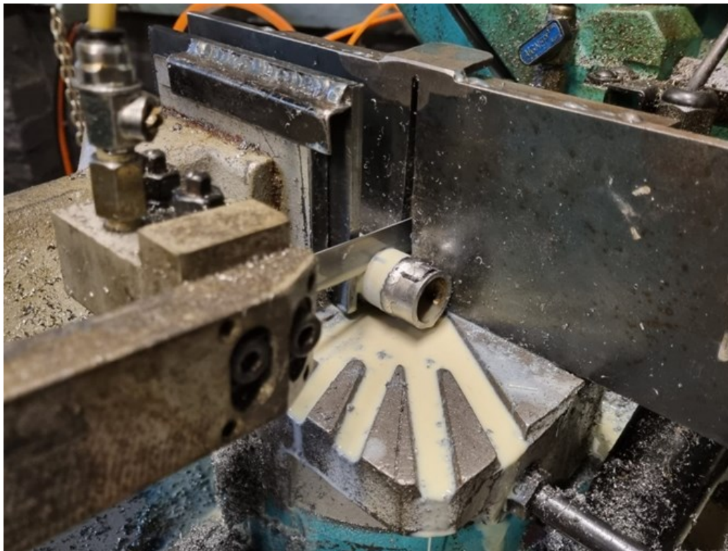
Slika 30. Postupak rezanja cijevi tračnom pilom
