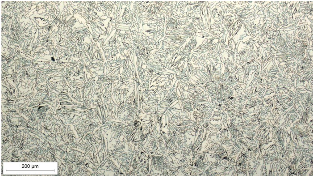
Slika 47. Mikrostruktura metala zavora u sredini zavora, snimljena pri povećanju 100×
