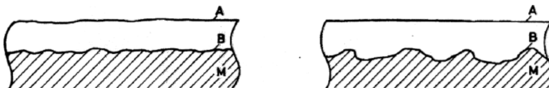
Slika 5. Ravnomjerna (lijevo) i neravnomjerna (desno) opća korozija [12]
