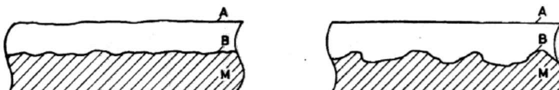
Slika 5. Ravnomjerna (lijevo) i neravnomjerna (desno) opća korozija [12]
