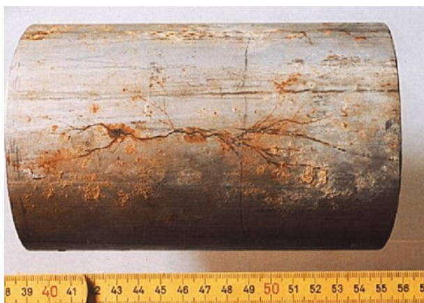
Slika 9. Napetosna korozija čelika [16]
