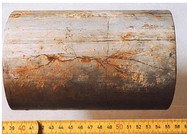
Slika 9. Napetosna korozija čelika [16]
