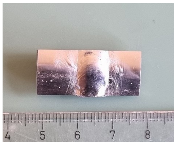
Slika 31. Izrezani uzorak zavarenog spoja cijevi
