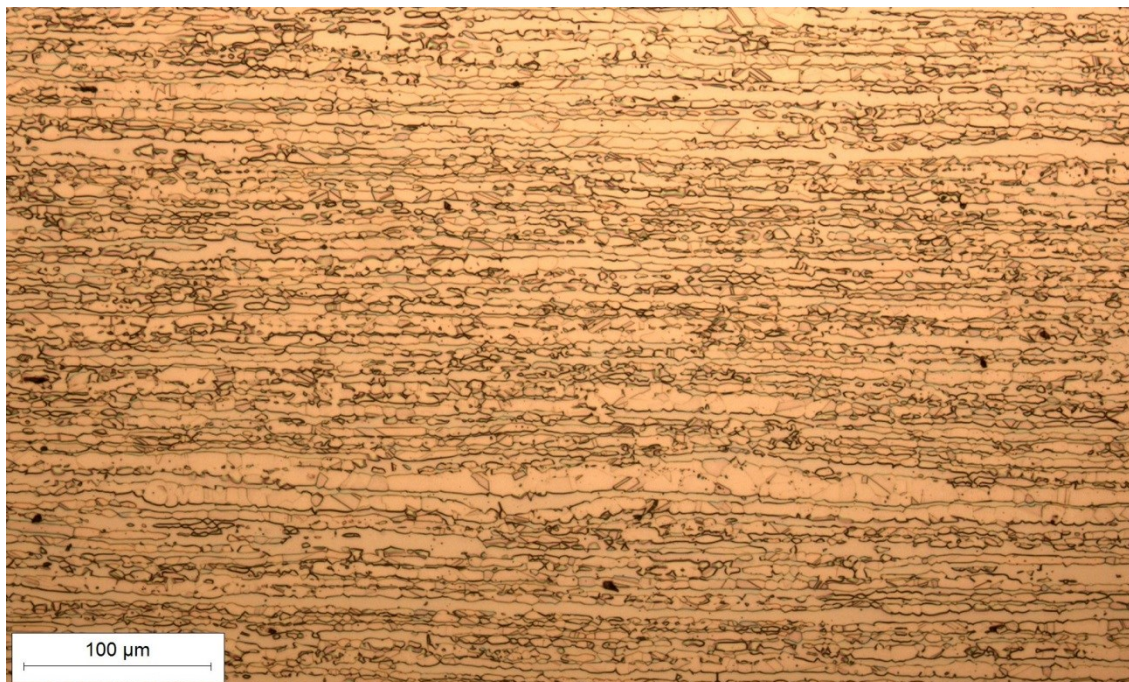
Slika 37. Mikrostruktura osnovnog materijala snimljena pri povećanju 200×
