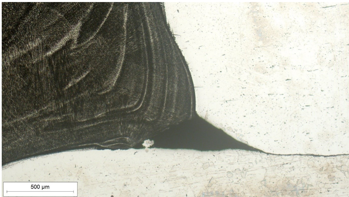
Slika 33. Korijen metala zavara snimljen pri povećanju 50×
