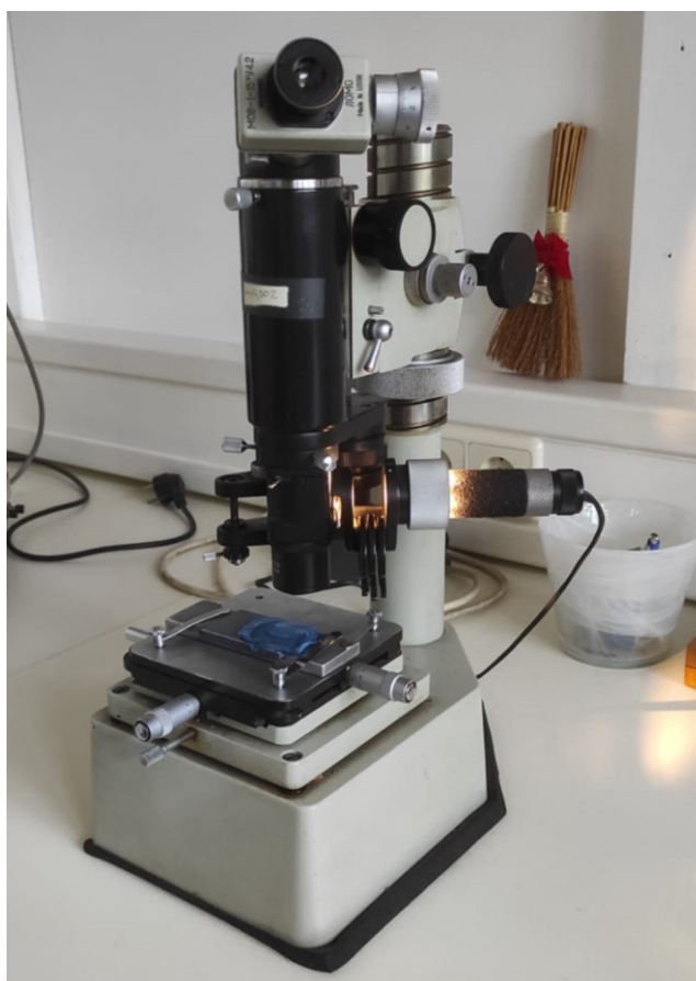
Slika 34. Uređaj za mjerenje mikrotvrdoće PMT-3
