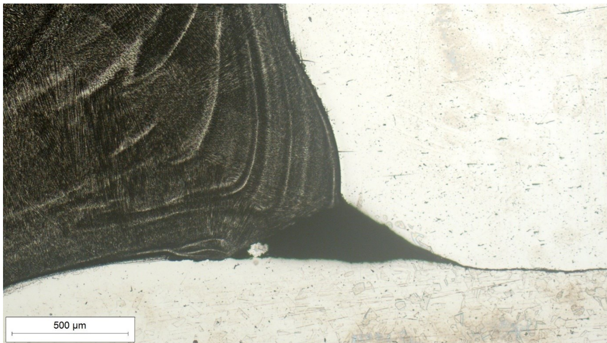
Slika 33. Korijen metala zavara snimljen pri povećanju 50×
