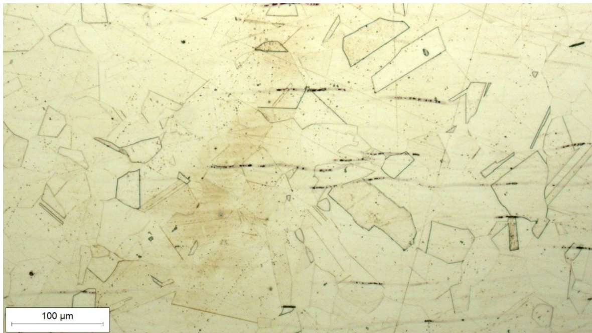
Slika 25. Mikrostruktura donjeg dijela ploče snimljena pri povećanju 200×
