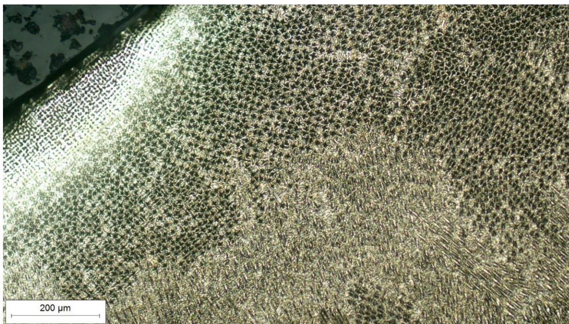
Slika 31. Tjeme metala zavara snimljeno pri povećanju 100×
