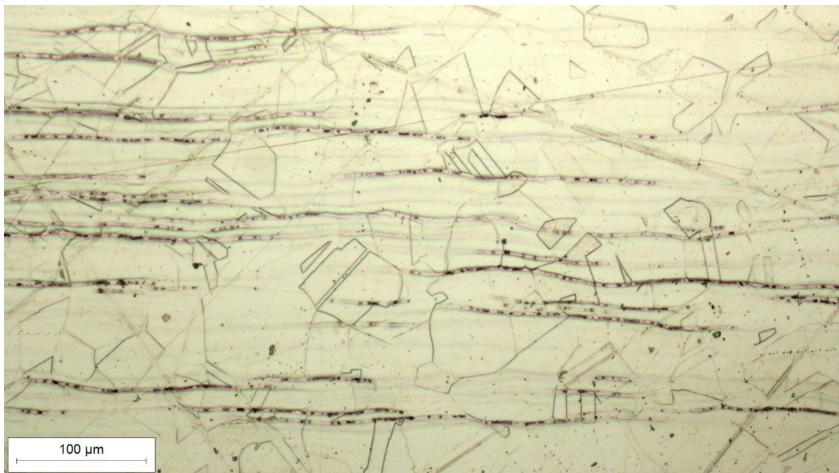
Slika 24. Mikrostruktura srednjeg dijela ploče snimljena pri povećanju 200×
