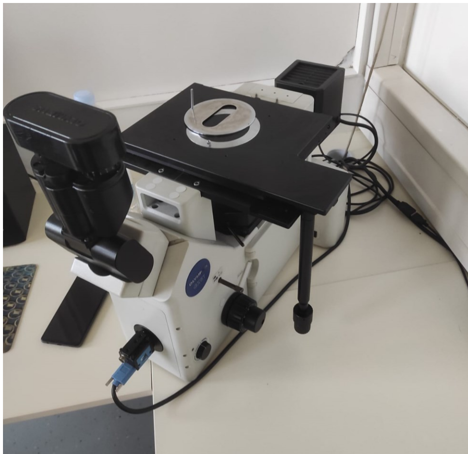
Slika 22. Svjetlosno mikroskop Olympus GX51
