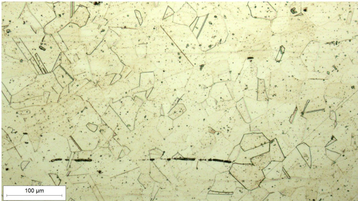
Slika 23. Mikrostruktura gornjeg dijela ploče snimljena pri povećanju 200×
