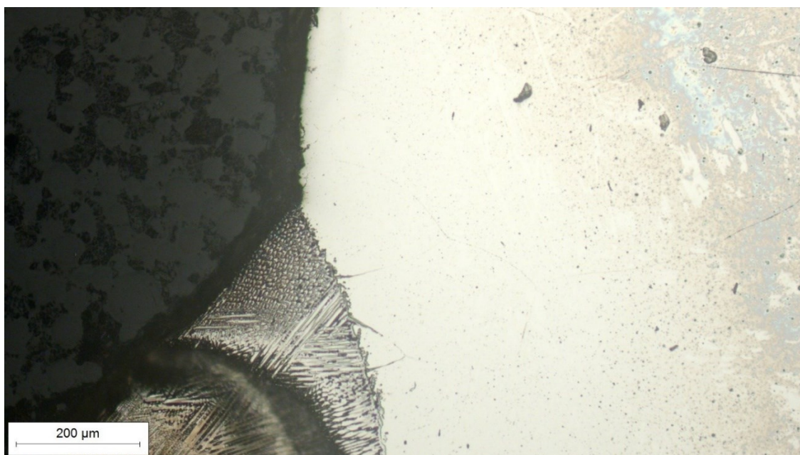
Slika 30. Zona utjecaja topline sa strane cijevi snimljena pri povećanju 100×
