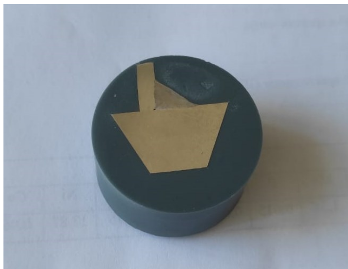
Slika 17. Metalografski uzorak zavarenog spoja
