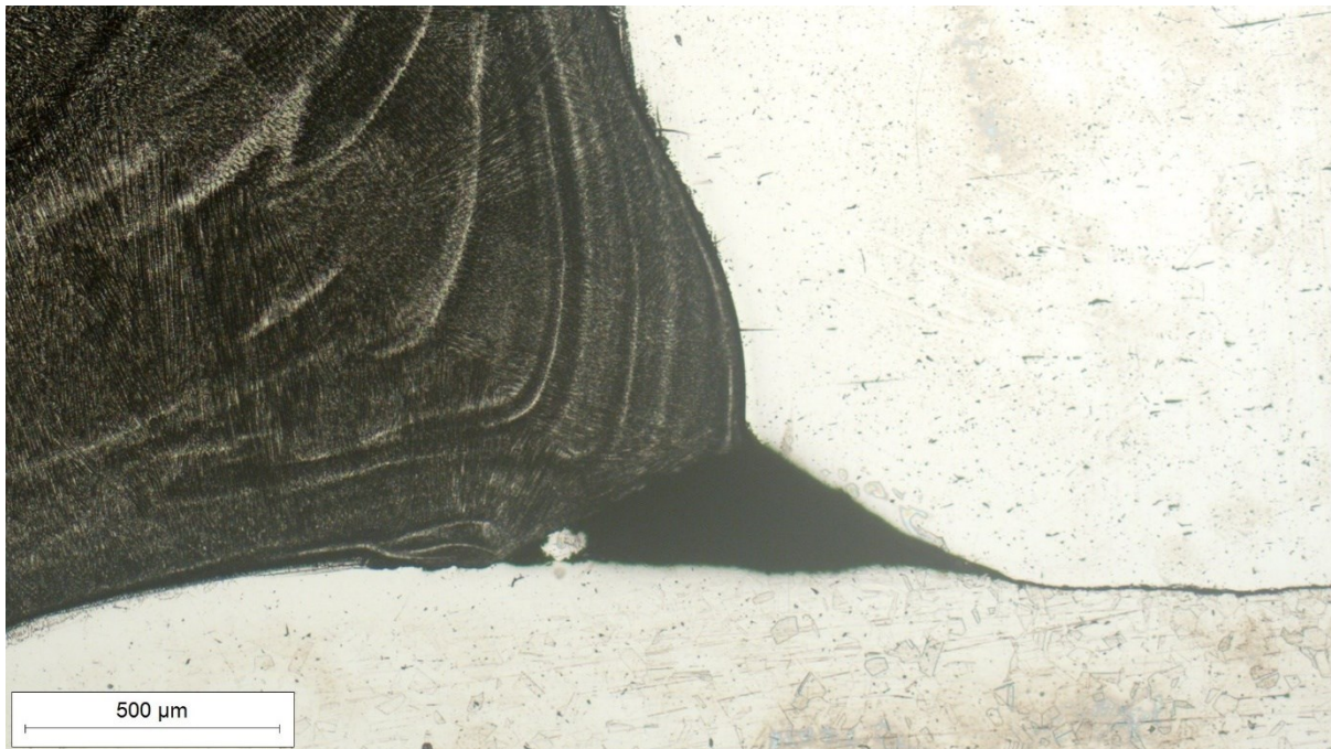
Slika 33. Korijen metala zavara snimljen pri povećanju 50×
