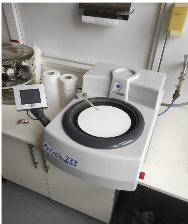
Slika 18. Uređaj za brušenje Presi Minitex 233
