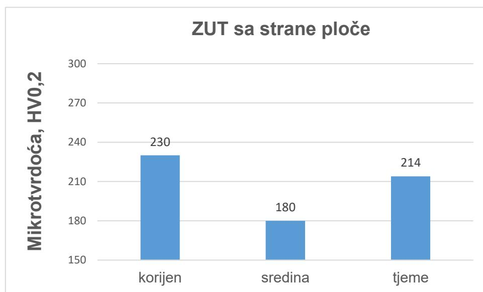
**Slika 38. Mikrotvrdoća ZUT-a sa strane ploče**
