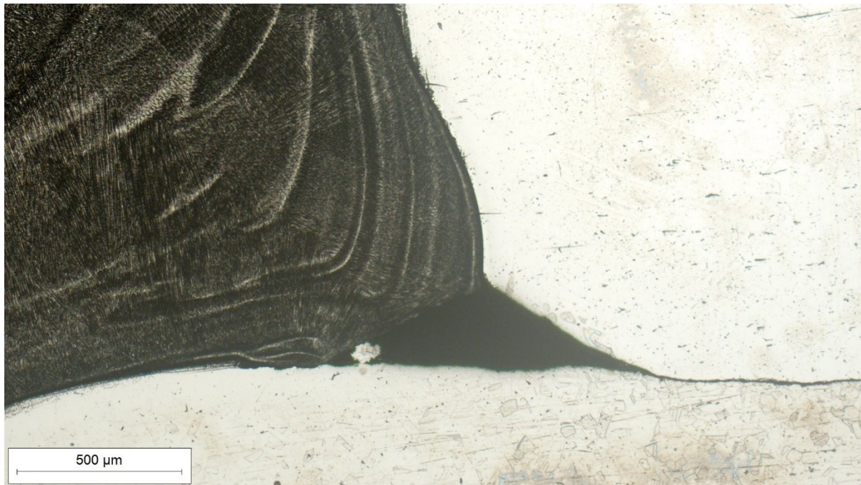
Slika 33. Korijen metala zavara snimljen pri povećanju 50×
