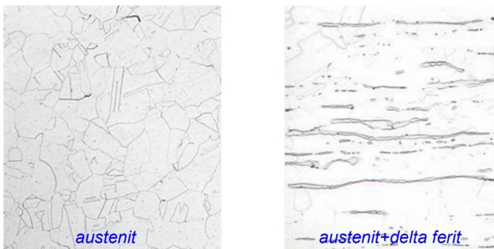
Slika 3. Mikrostruktura dvaju austenitnih nehrđajućih čelika [1]
