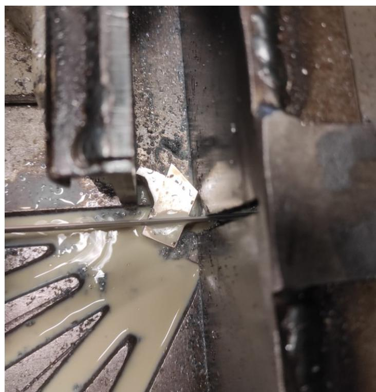
Slika 14. Izrezivanje uzorka (ploča)
