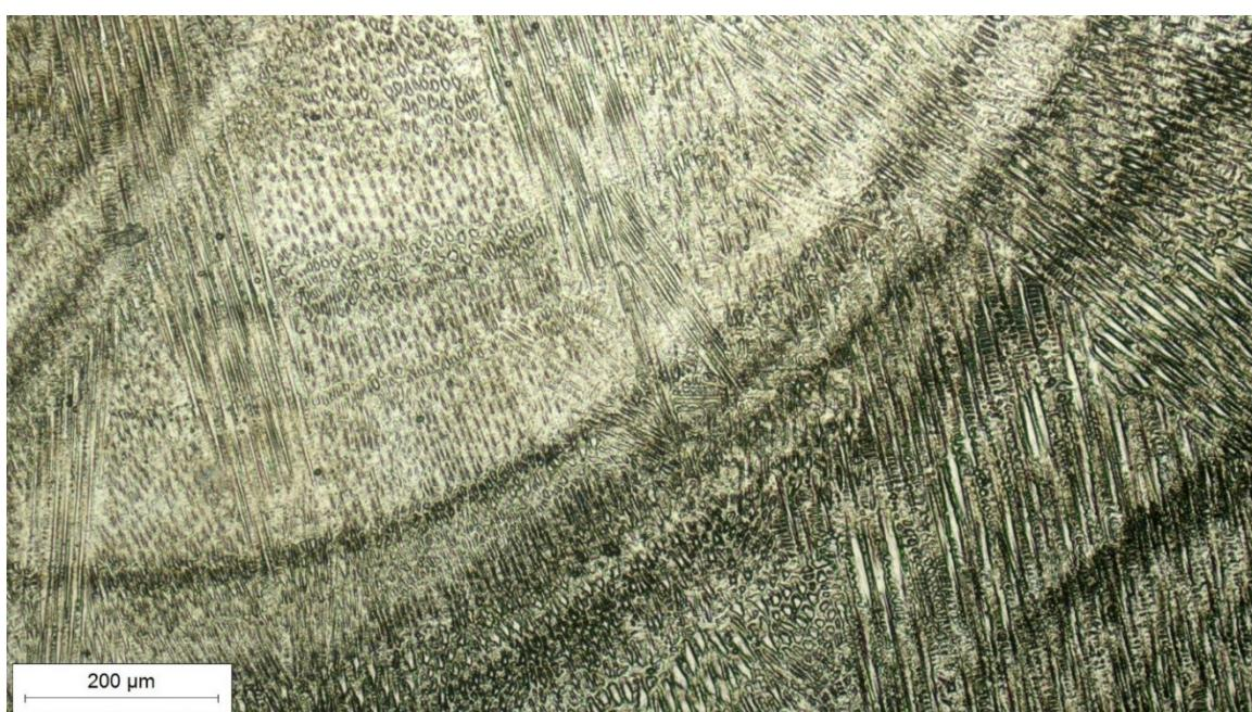
Slika 32. Sredina metala zavara snimljena pri povećanju  $100\times$
