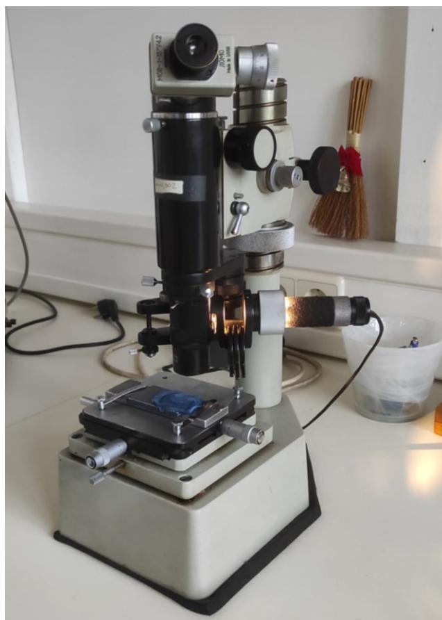
Slika 34. Uredaj za mjerenje mikrotvrdoće PMT-3
