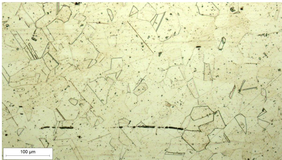
Slika 23. Mikrostruktura gornjeg dijela ploče snimljena pri povećanju 200×
