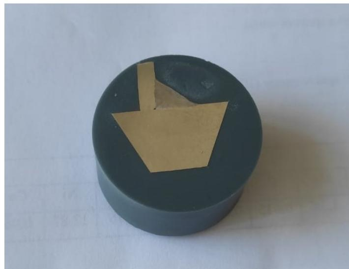
**Slika 17. Metalografski uzorak zavarenog spoja**
