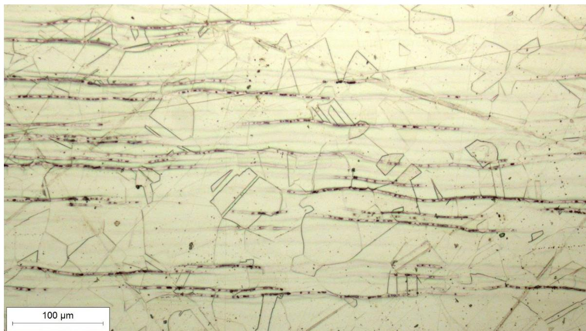
Slika 24. Mikrostruktura srednjeg dijela ploče snimljena pri povećanju 200×
