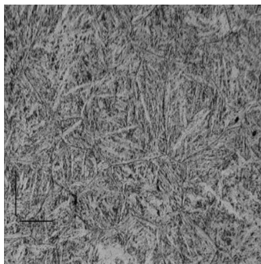
Slika 5. Mikrostruktura martenzitnog čelika s potpuno martenzitnom mikrostrukturom [11]
