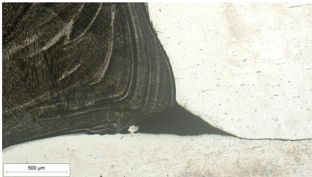
Slika 33. Korijen metala zavara snimljen pri povećanju  $50\times$
