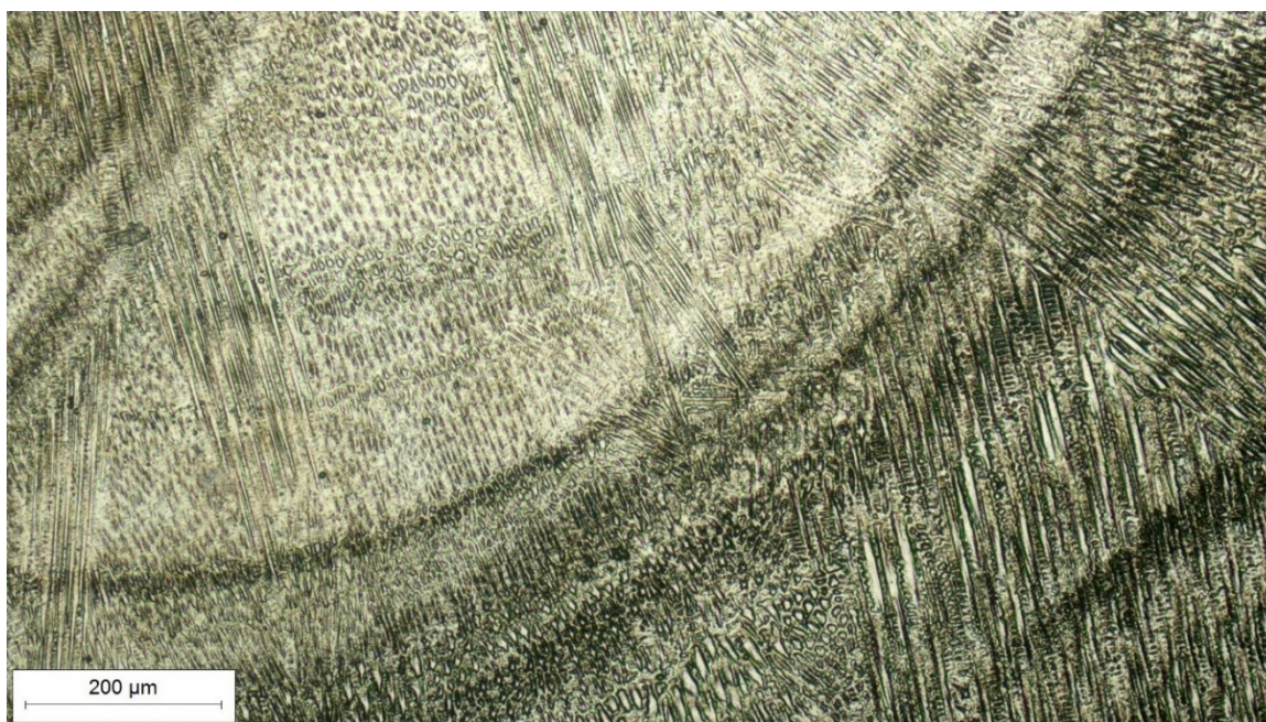
Slika 32. Sredina metala zavara snimljena pri povećanju 100×
