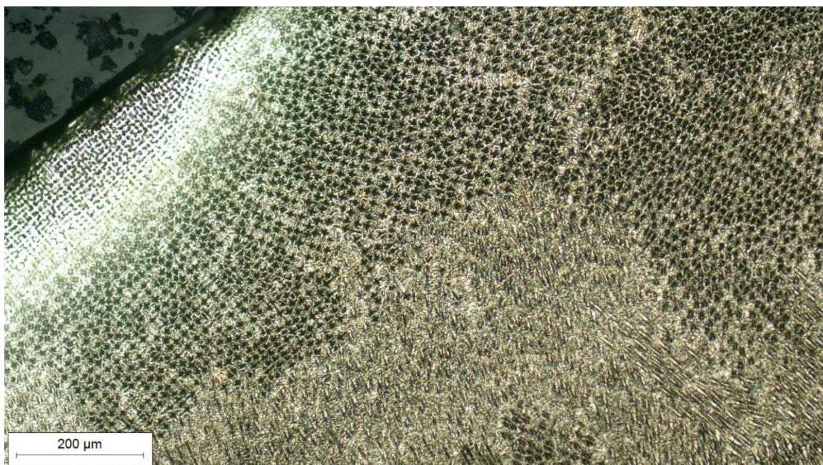
Slika 31. Tjeme metala zavara snimljeno pri povećanju  $100\times$
