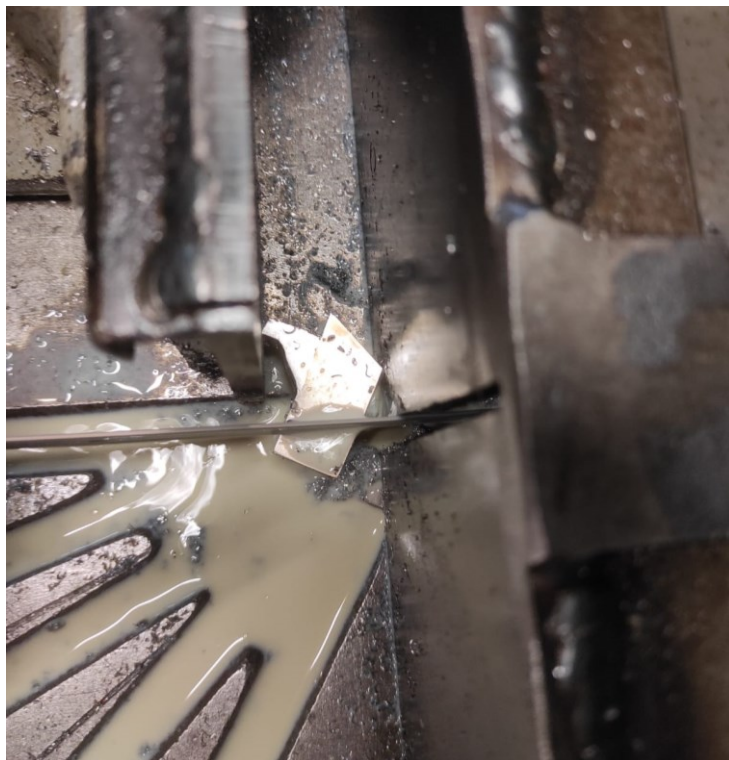
Slika 14. Izrezivanje uzorka (ploča)
