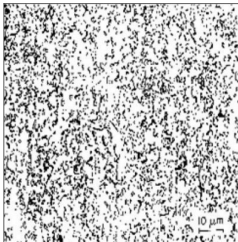
Slika 4. Prikaz mikrostrukture meko žarenog čelika X20Cr13 [11]
