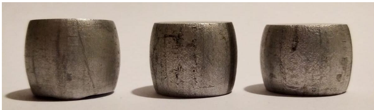
Slika 22. Uzorci nakon deformacije gdje su kontaktne površine bile hrapavo – hrapavo
