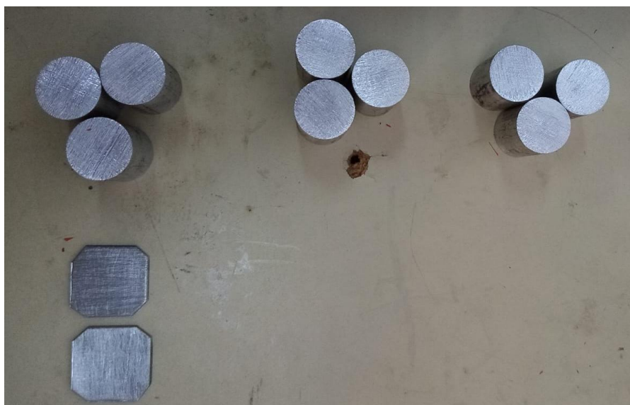
Slika 18. Uzorci prije deformacije i čelične pločice
