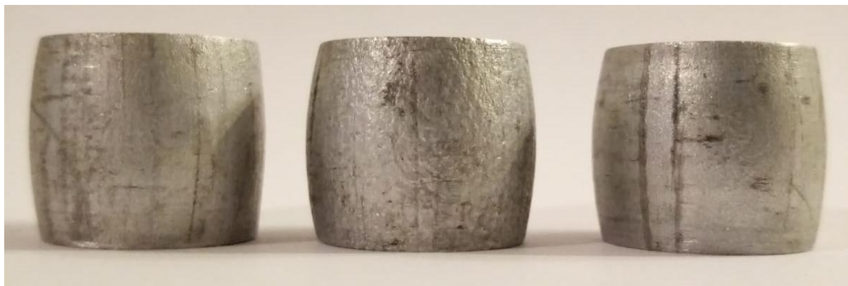
Slika 21. Uzorci nakon deformacije gdje su kontaktne površine bile glatko – hrapavo
