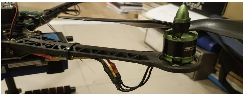
Slika 11. Motor sa propelerom
