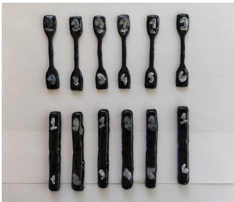
Slika 13: Epruvete 1. serije - 170 °C bez soli
