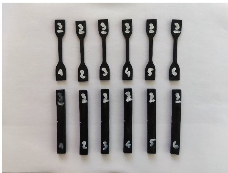
Slika 15: Epruvete 3. serije - bez soli 110 °C
