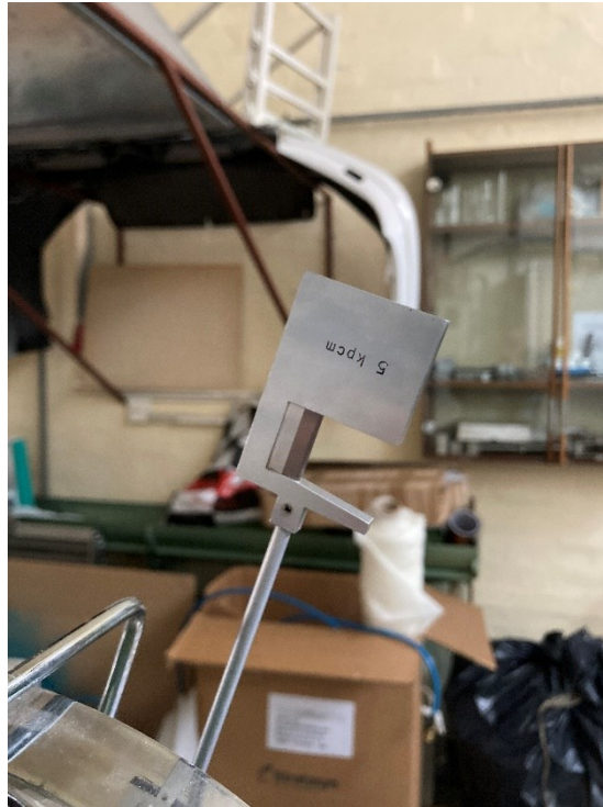
Slika 25: Bat mase 5 kpcm korišten u pokusu
