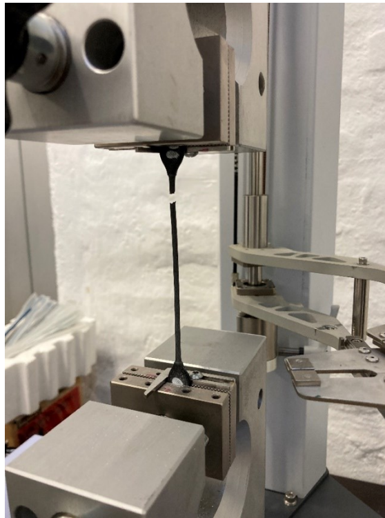
Slika 31: Primjer pogreške gdje epruveta ne puca na sredini
