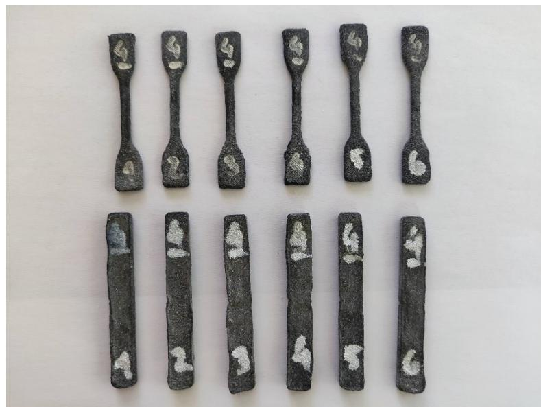
Slika 16: Epruvete 4. serije - sol pri  $235\text{ }^{\circ}\text{C}$
