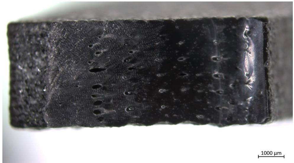
Slika 35: Primjer epruvete 2 - presjek nakon rasteznog pokusa
