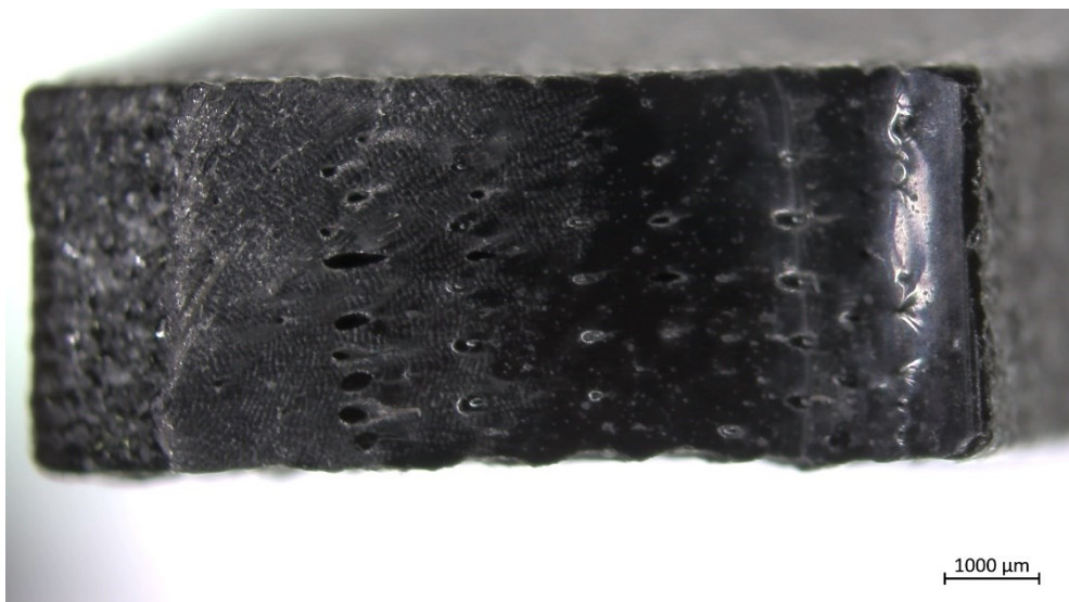
Slika 35: Primjer epruvete 2 - presjek nakon rasteznog pokusa
