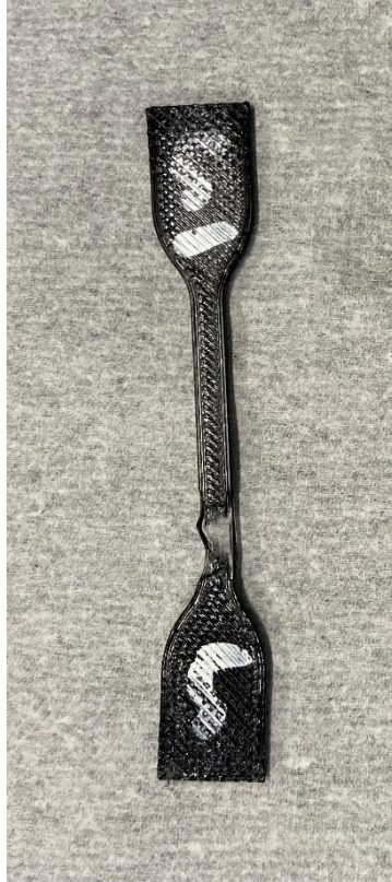
Slika 30: Primjer epruvete koja nije puknula na sredini
