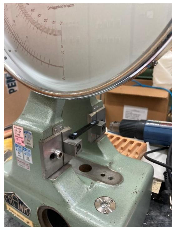
Slika 26: Položaj epruvete na uređaju za mjerjenje udarne žilavosti
