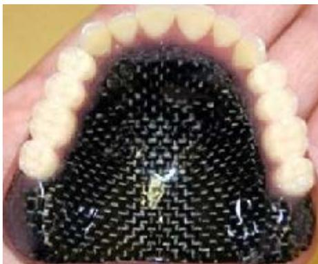
Slika 6. Zubna proteza ojačana tkanim ugljičnim vlaknima [7]
