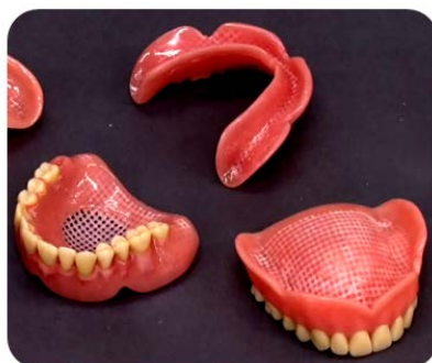
Slika 10. Baza zubne proteze ojačana tkanim staklenim vlaknima [7]
