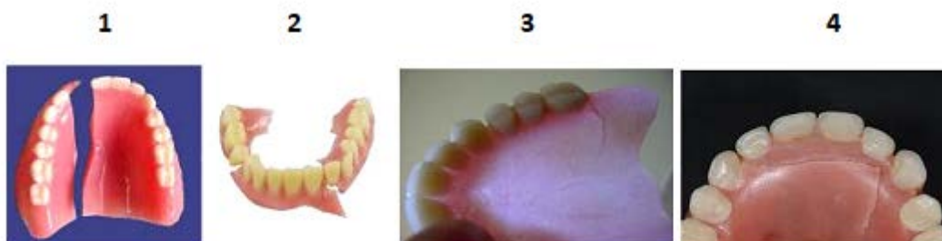
Slika 2. Slomljene zubne proteze (1,2) i napukline u bazi proteze uslijed zamora materijala (3,4) [4].
