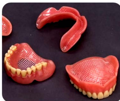
Slika 10. Baza zubne proteze ojačana tkanim staklenim vlaknima [7]
