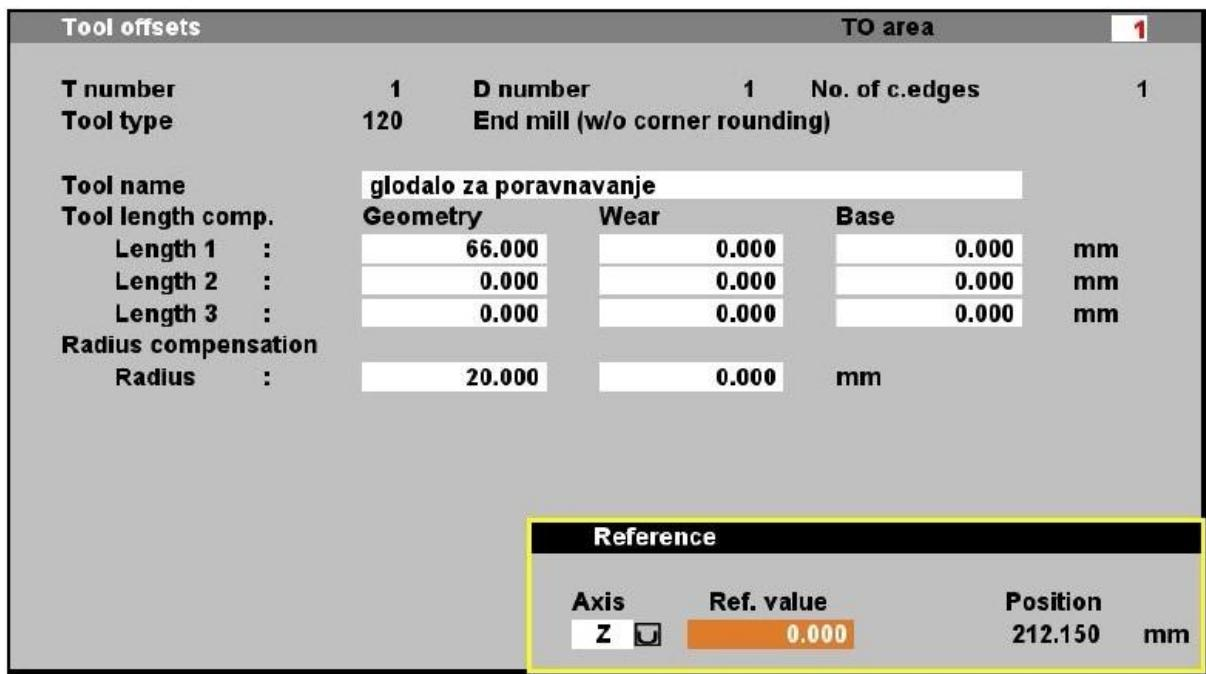
Slika 3.14 – Sučelje *Tool offset* pri podešavanju Z osi kod glodalice
