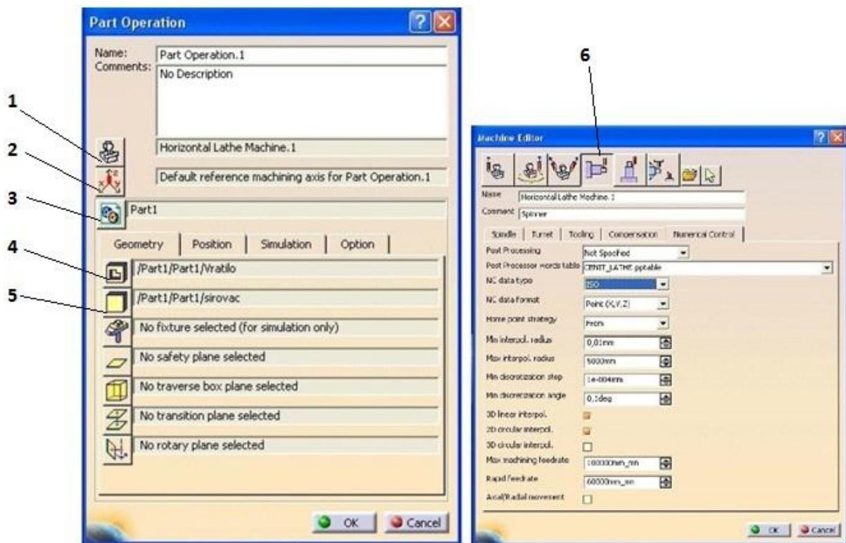
Slika 5.9 – Izbornik za definiranje osnovnih postavki (*Part Operation.1*)
