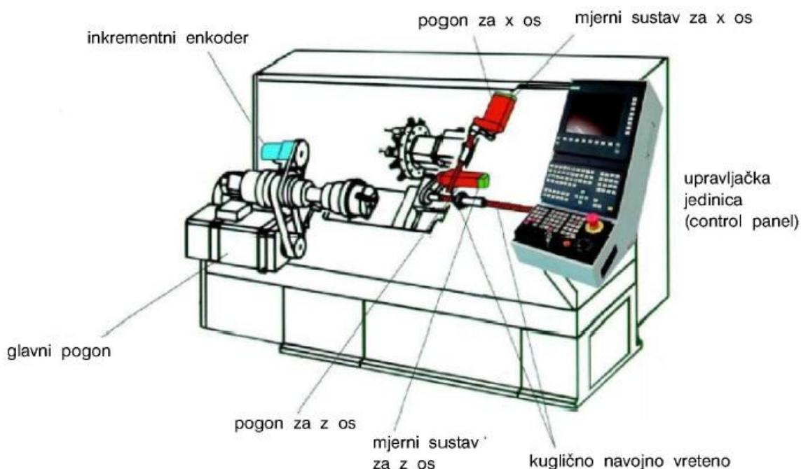
Slika 2.4 – Dijelovi tokarilice
