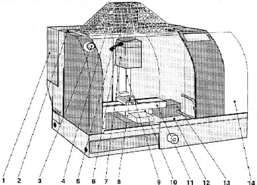
Slika 2.15 – Shematski prikaz stroja *EMCO PC MILL 55*
