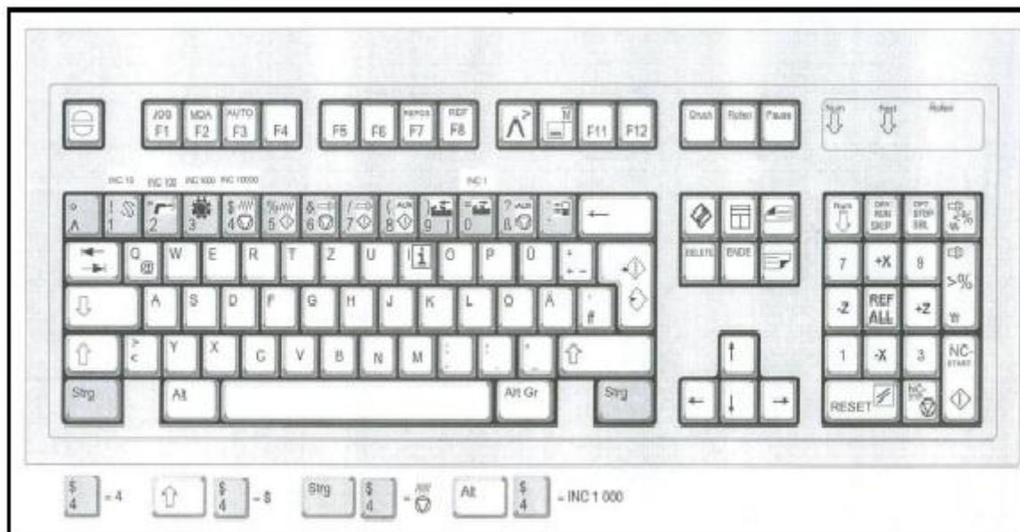
Slika 3.3 – PC tipkovnica za upravljanje NC strojem
