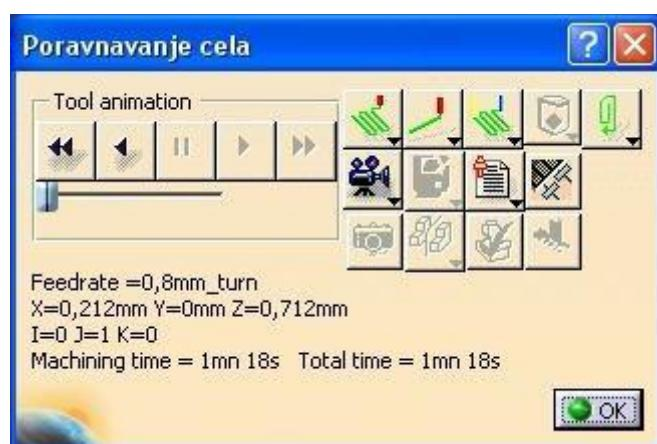
Slika 5.25 – Prozor za simulaciju putanje alata
