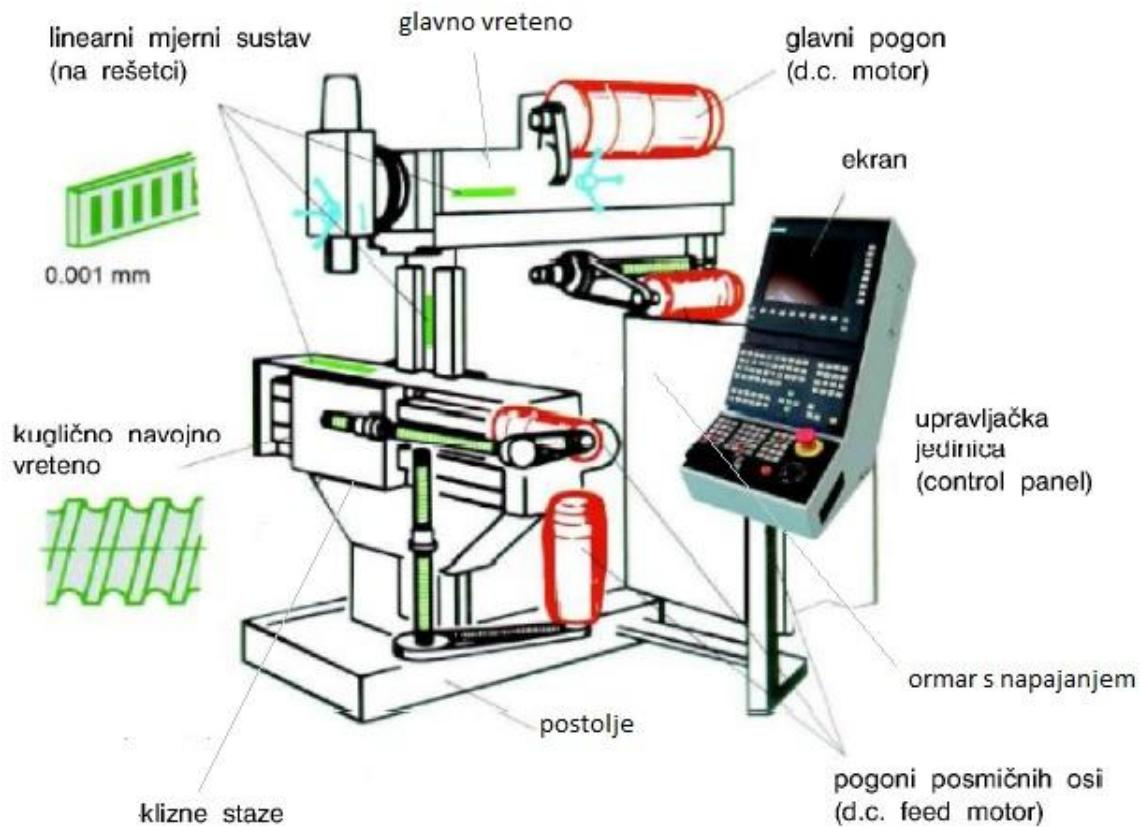
Slika 2.5 – Dijelovi glodalice
