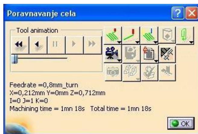
Slika 5.25 – Prozor za simulaciju putanje alata
