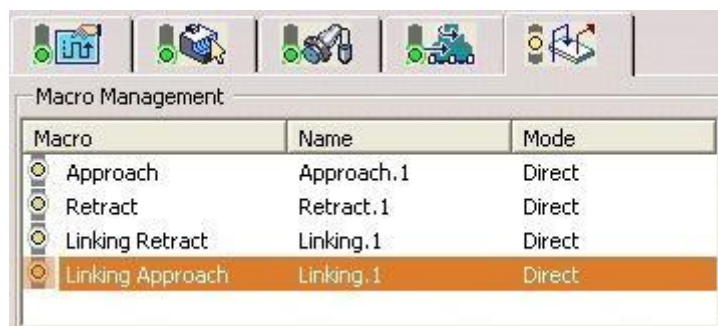
Slika 5.23 – Izbornik za definiranje načina prilaza alata nakon obavljene kalibracije
