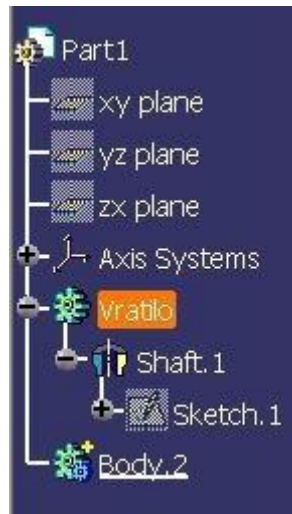
Slika 5.2 – Izgled konfiguracijskog stabla nakon izvršenja naredbe Insert – Body
