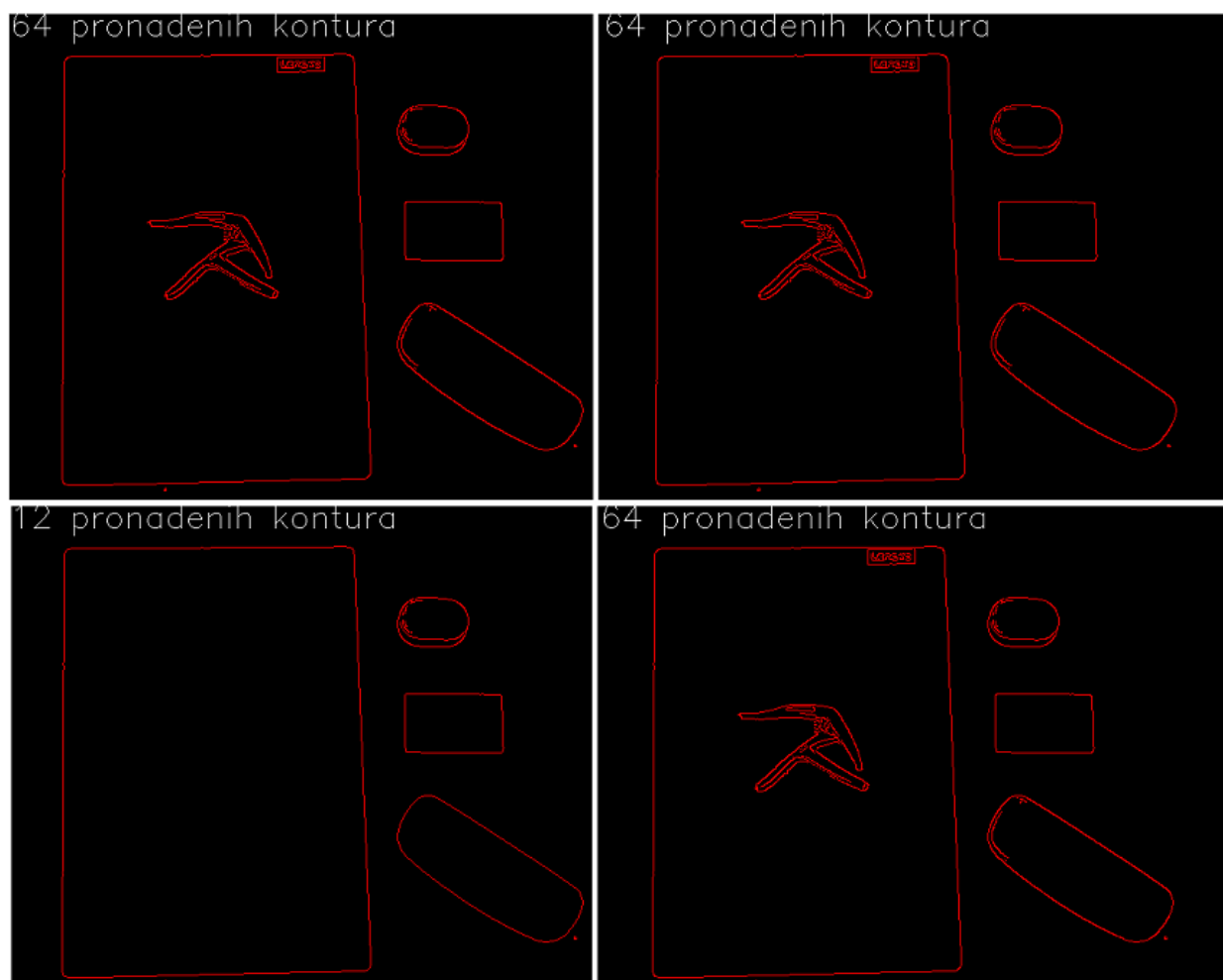
Slika 28. Canny rubovi pomoću CHAIN_APPROX_SIMPLE i svih hijerarhijskih metoda
