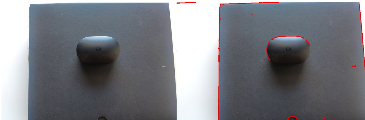
Slika 33. Canny metoda kod lošeg osvjetljenja
