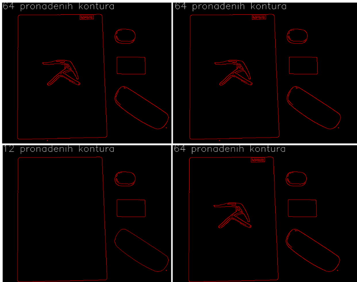
Slika 27. Canny rubovi pomoću CHAIN_APPROX_NONE i svih hijerarhijskih metoda
