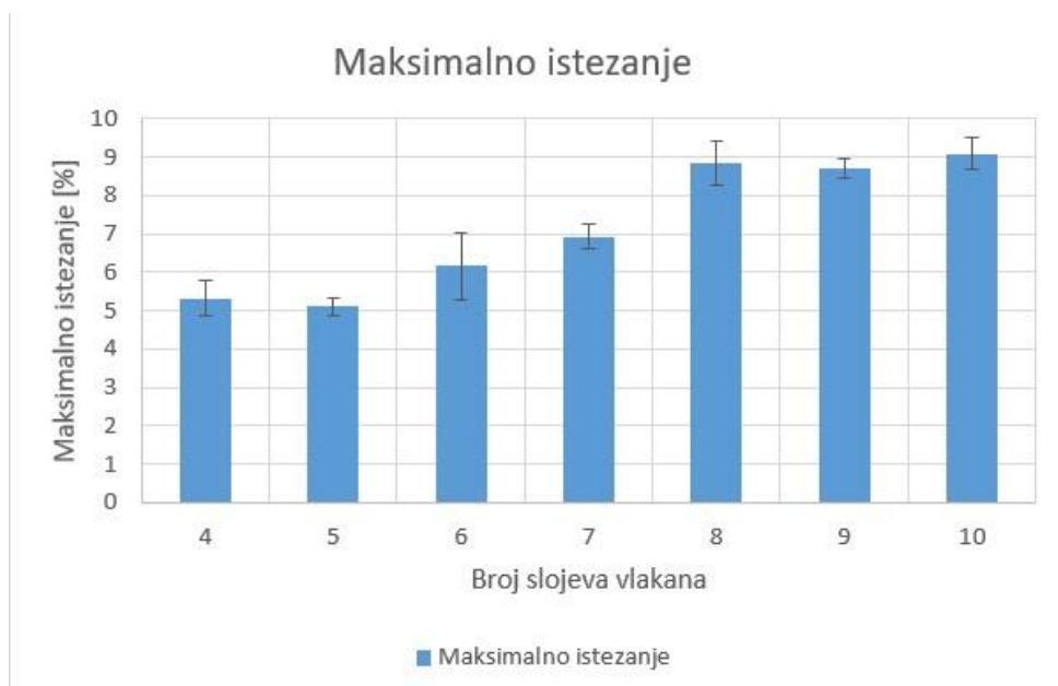
Slika 25. Grafički prikaz promjene maksimalnog istezanja u ovisnosti o broju slojeva vlakana u kompozitu kod rasteznog ispitivanja
