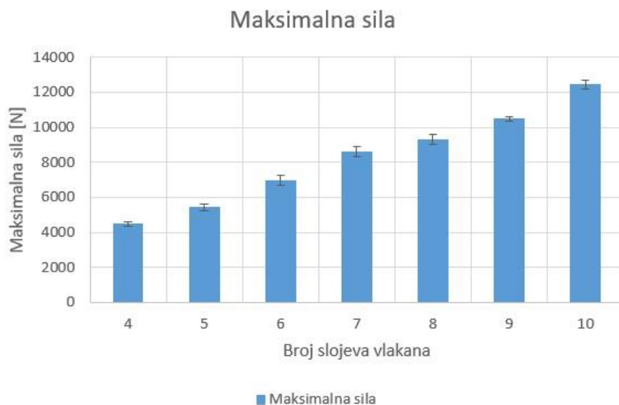
Slika 24. Grafički prikaz promjene maksimalne sile u ovisnosti o broju slojeva vlakana u kompozitu kod rasteznog ispitivanja
