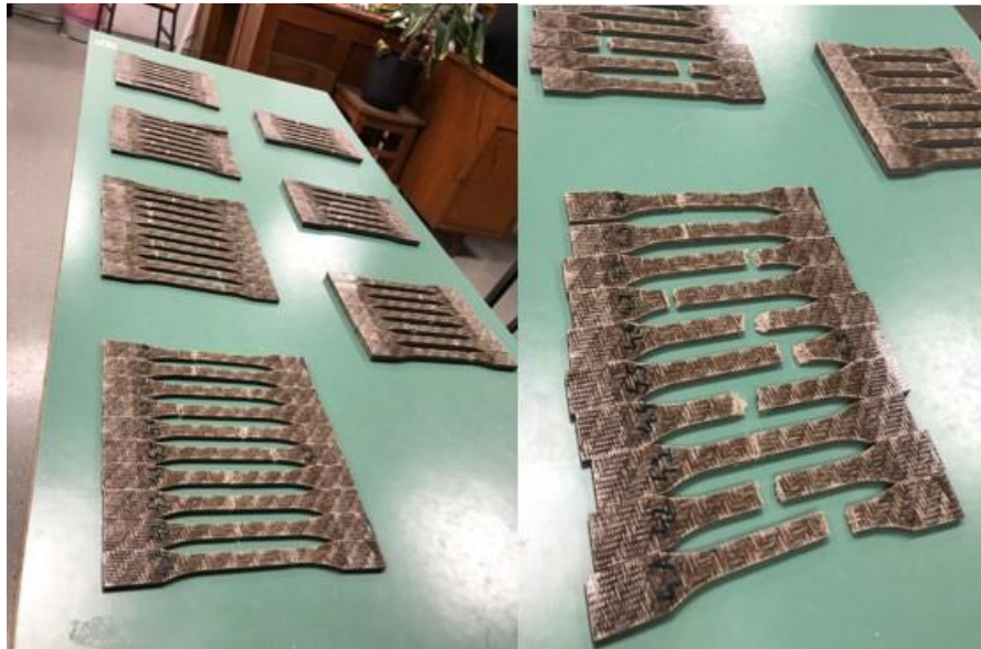
Slika 16. Uzorci nakon provedenog rasteznog ispitivanja
